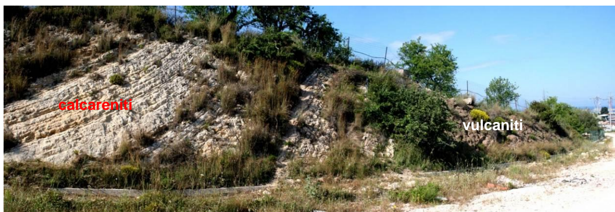
Figura 2.7 -Contatto in affioramento tra calcareniti (sx) e vulcaniti (dx) nella parte terminale del tracciato, nei pressi della S.E. Priolo Gargallo
