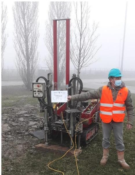
*Figura 47: posizionamento penetrometro per esecuzione CPTU 1*
