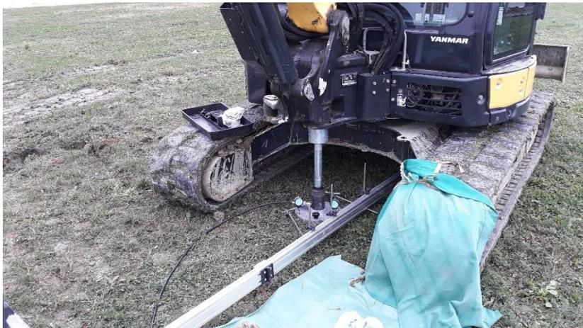
*Figura 50: approntamento strumentazione per esecuzione prova di carico P1*
