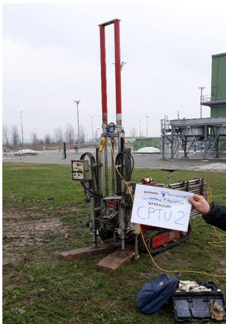
*Figura 48: posizionamento penetrometro per esecuzione CPTU 2*
