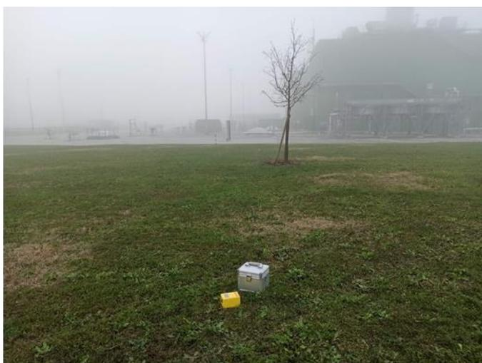
*Figura 56: posizionamento Tromino per HVSR*
