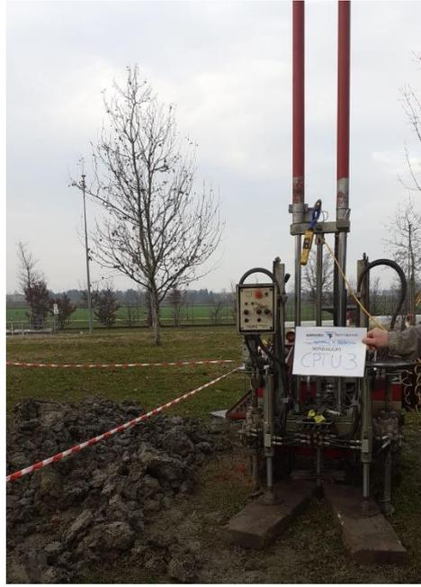
*Figura 49: posizionamento penetrometro per esecuzione CPTU 3*
