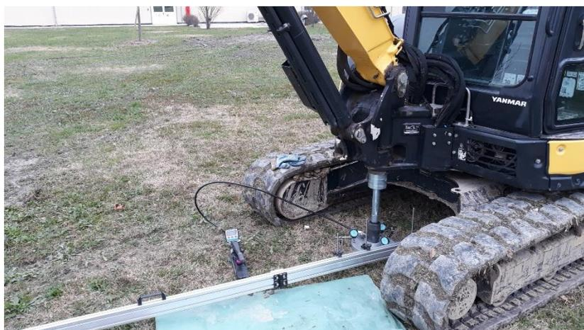
*Figura 51: approntamento strumentazione per esecuzione prova di carico P2*
