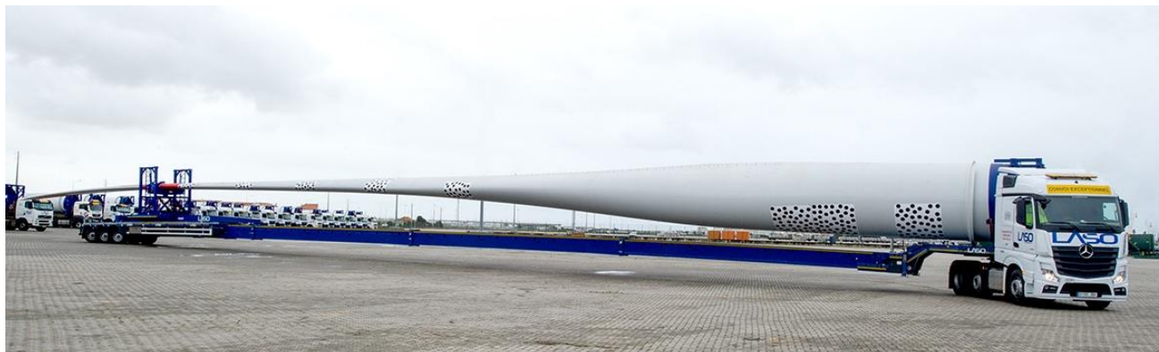
Figura 1 Esempio di trasporto pale con tipologia SWC
