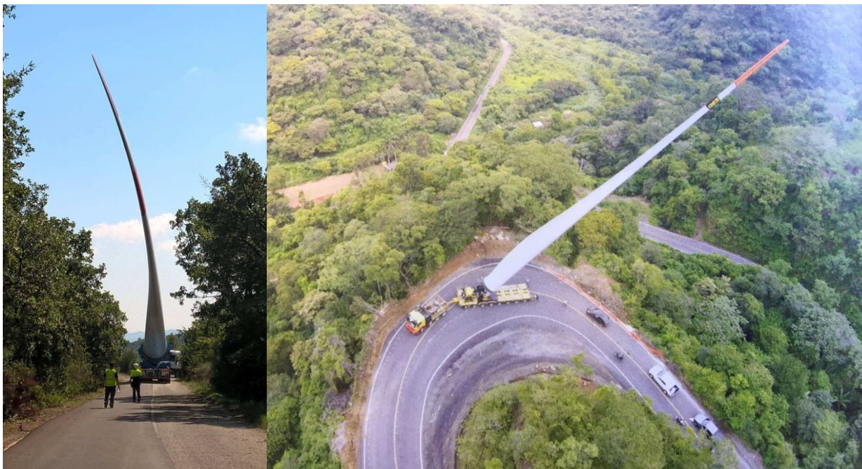
Figura 13 Esempio di trasporto con Blade lifter trailer
