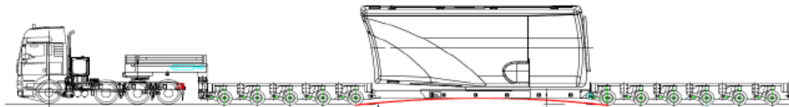
Figura 8 Schema tipo per il trasporto della navicella
