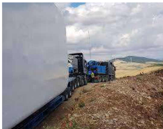
Figura 124 - Esempio di trasporto con convogli a pianale allungabile della navicella
