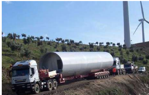
Figura 123 - Esempio di trasporto con convogli a pianale allungabile dei conci di torre
