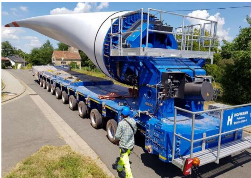
Figura 122 - Sistemi di trasporto pale: Blade Lifter
