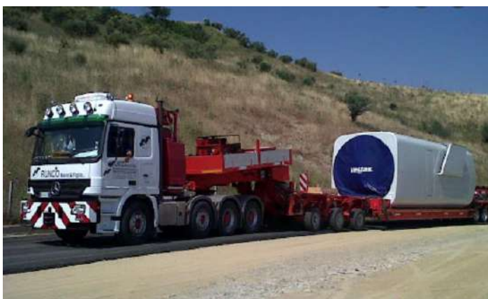
Figura 124 - Esempio di trasporto con convogli a pianale allungabile della navicella
