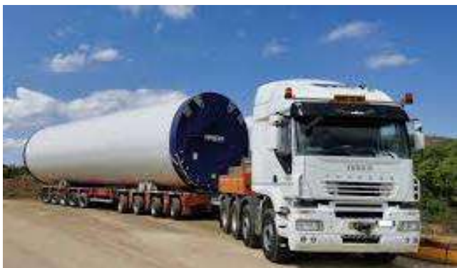
Figura 123 - Esempio di trasporto con convogli a pianale allungabile dei conci di torre
