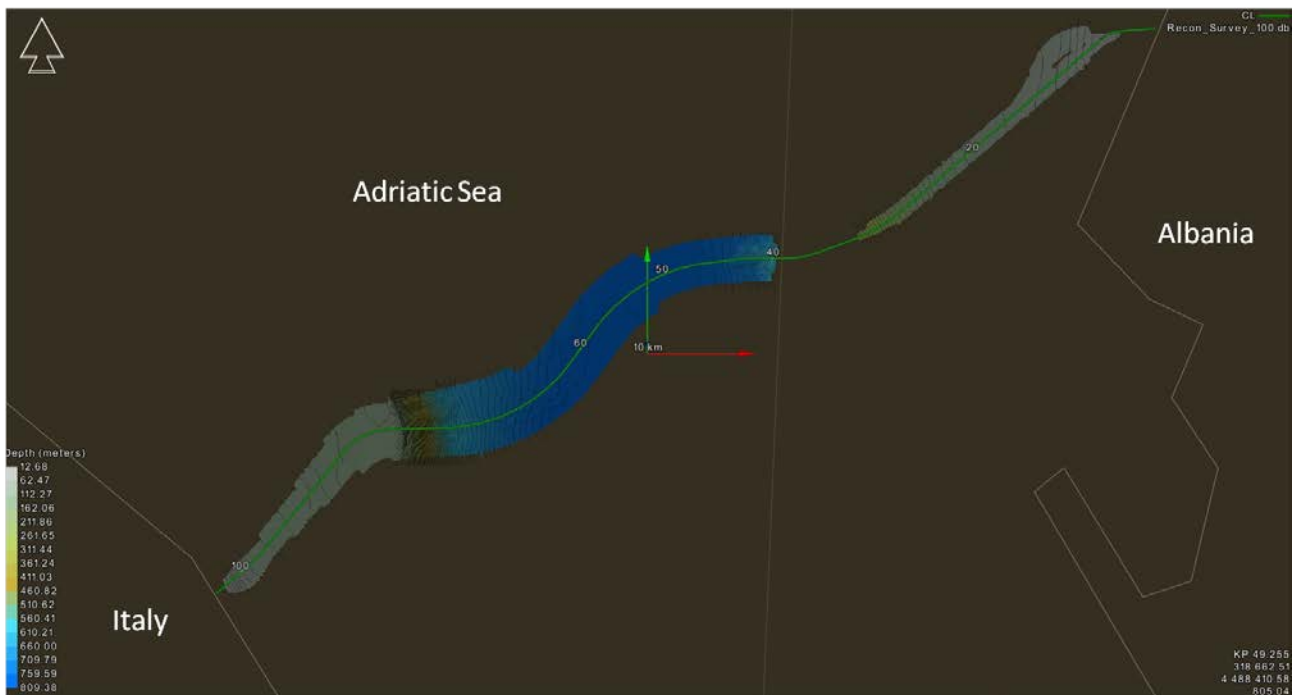
Figura 3.1 Mappa della batimetria lungo la rotta. L'area di massima profondità coincide con il Bacino Adriatico (colore blu).
