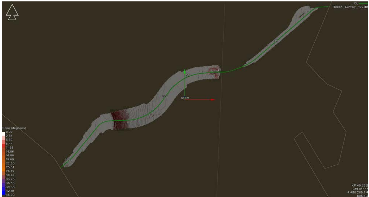
Figura 3.2 Mappa dei gradienti di pendenza del fondale marino lungo la rotta. Le aree con il massimo gradiente sono associate alla scarpata Italiana e al deposito di frana sulla scarpata Albanese (colore rosso).
