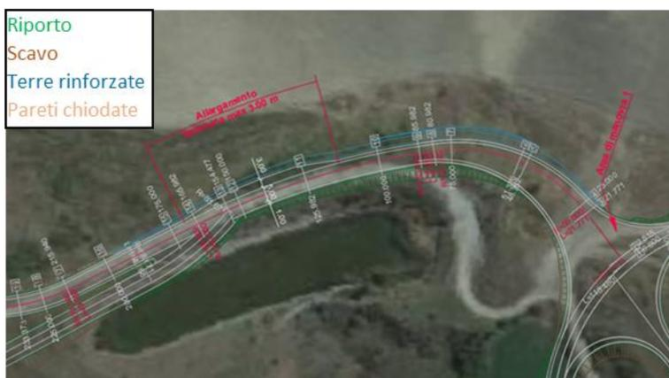
Figura 34: Dettaglio ubicazione allargamento banchina e terre rinforzate –
