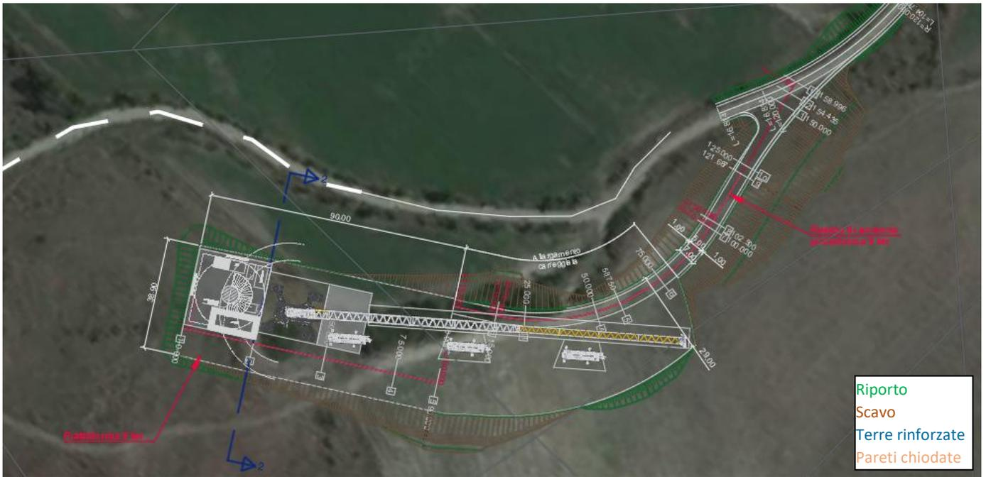
Figura 68: Pianta Layout piazzola WTG9
