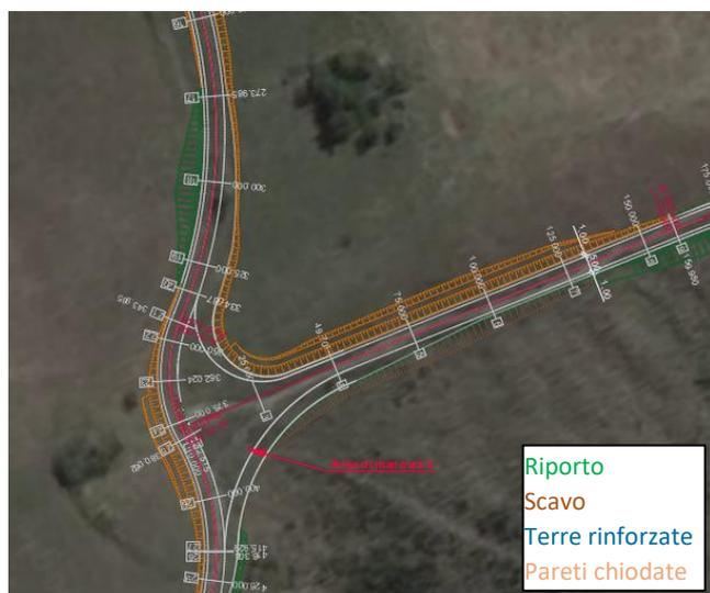
Figura 37: Dettaglio ubicazione pareti chiodate
