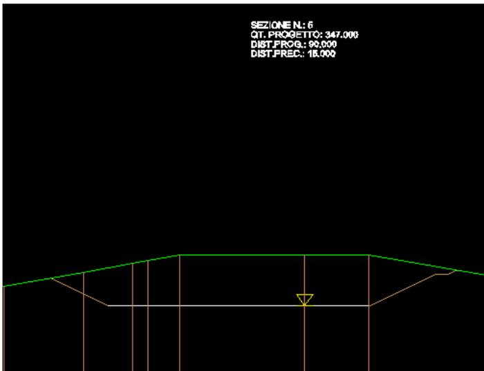
Figura 69: Dettaglio scarpate (1/2 – h/l) piazzola – Sez. 5 – WTG9
