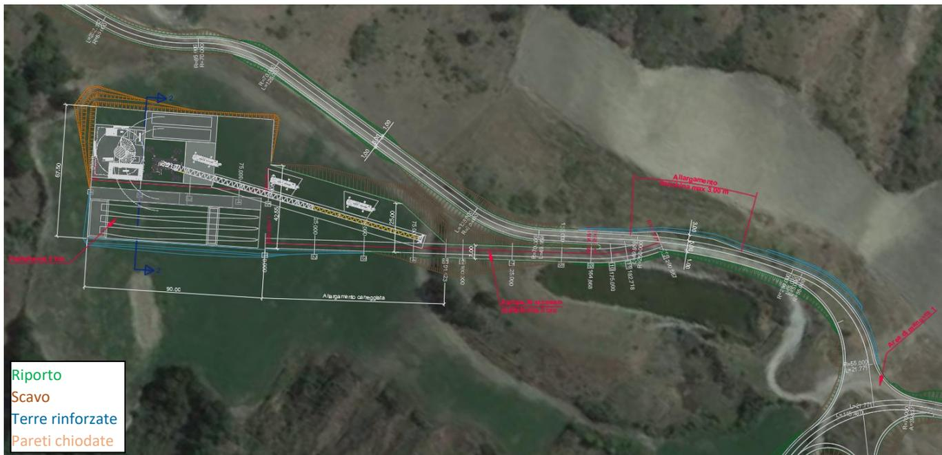
Figura 59: Pianta Layout piazzola WTG5
