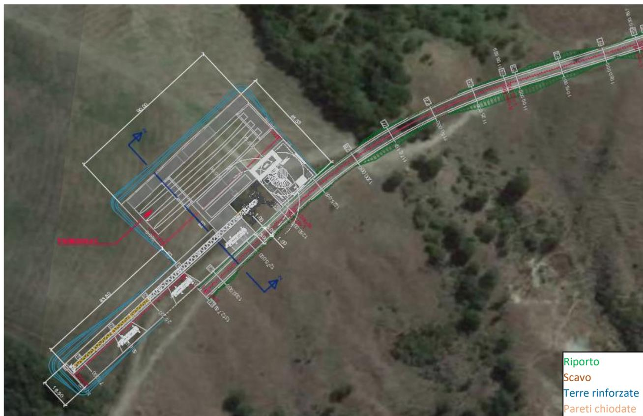
Figura 62: Pianta Layout piazzola WTG6
