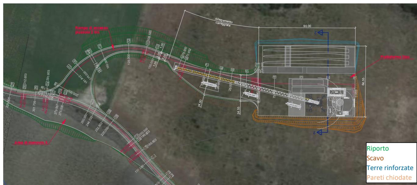
Figura 53: Pianta Layout piazzola WTG2
