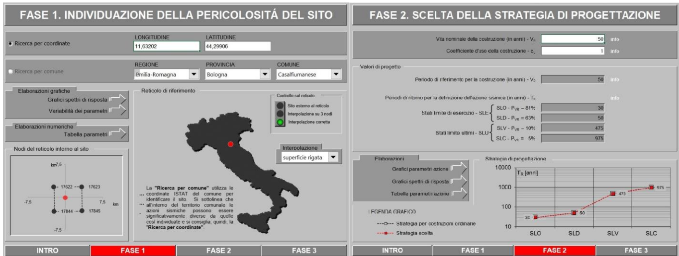
Figura 5 Parametri indipendenti dello spettro di risposta per la zona in esame
