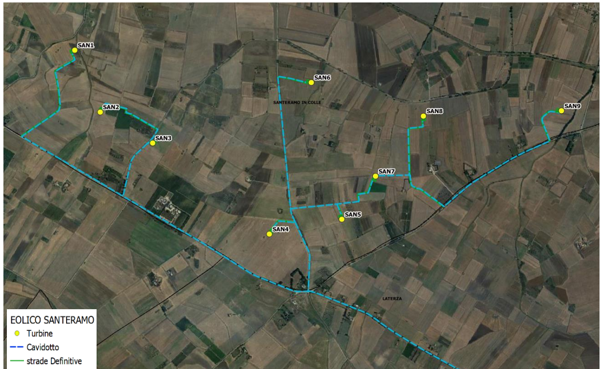
Figure 2 Planimetria generale di progetto su base CTR ed ortofoto con ubicazione turbine di progetto
