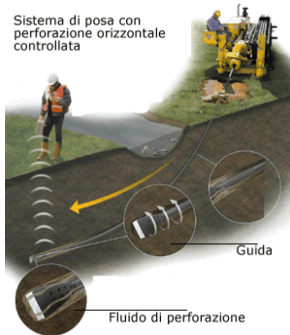
Figure 11-Sistema di trivellazione orizzontale controllata (T.O.C.).
