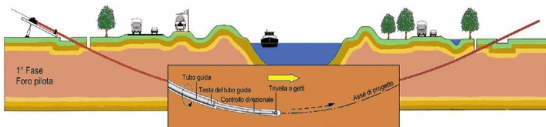
Figure 12 – Schema della fase di realizzazione del foro pilota.
