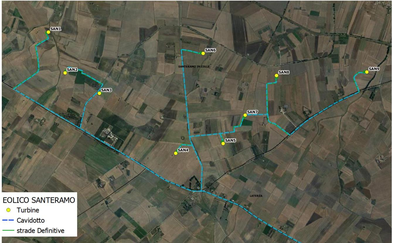
**Figura 2-4: Area di sito: dettaglio layout di progetto su ortofoto**
