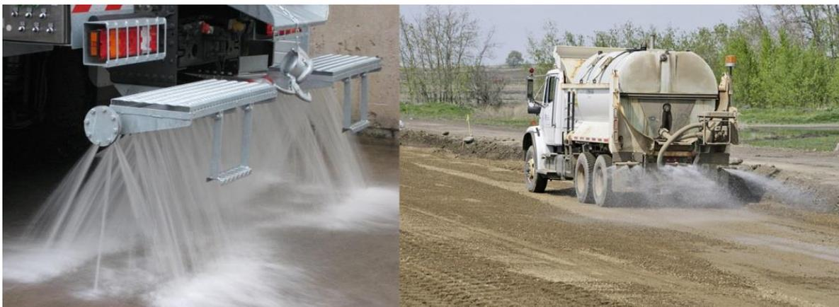
**Figura 8-1: Automezzo per la bagnatura delle piste sterrate**
