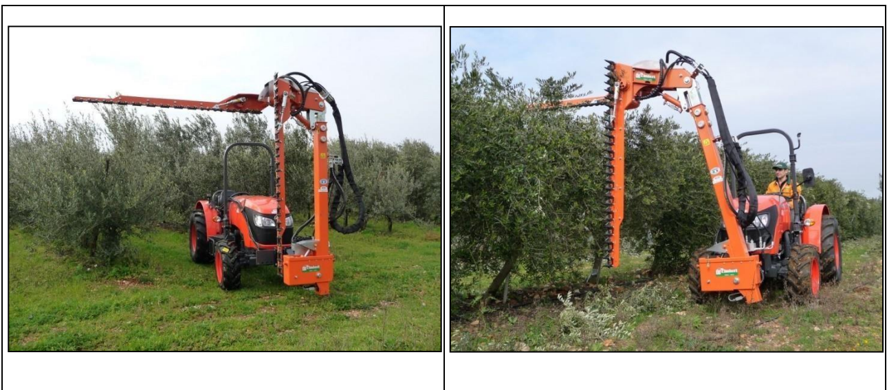
Figura 16) Esempio di potatrice meccanica frontale a doppia barra (taglio verticale + topping) utilizzabile su tutte le colture arboree intensive e superintensive (Foto: Rinieri S.r.l.)
