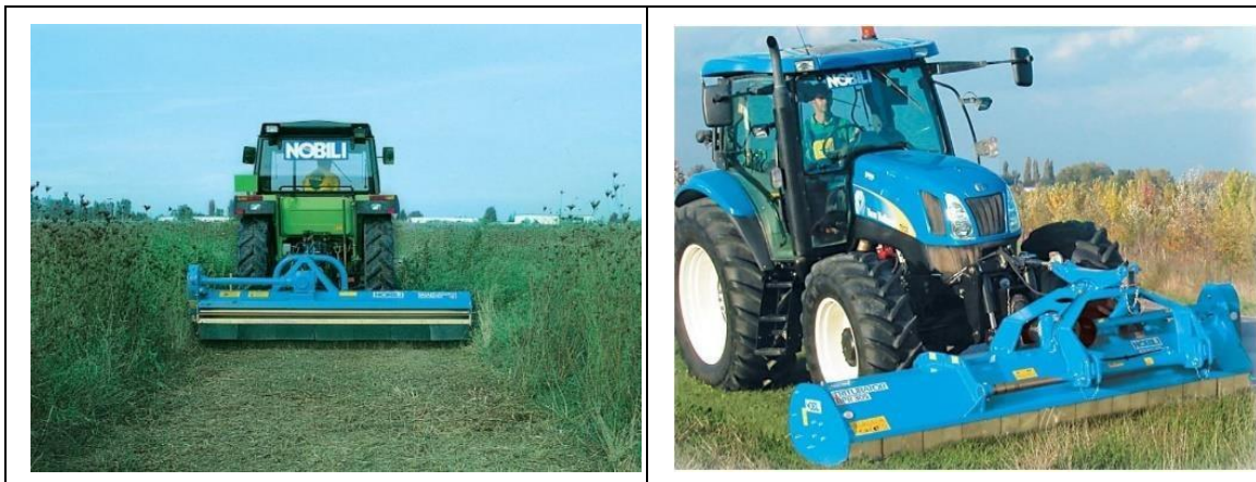
Figura 12) Esempi di trincia posteriore e anteriore di notevole larghezza (Foto: Nobili S.r.l.)
