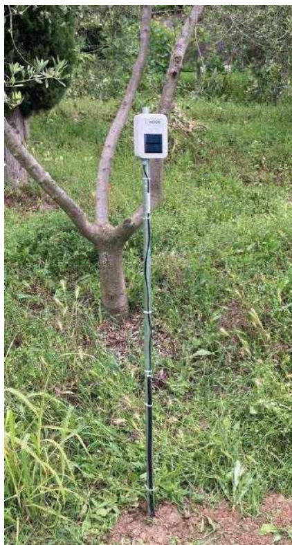
Figura 23) Esempio di sensore di rilievo dato temperatura e umidità del suolo (parte infissa nel terreno)
