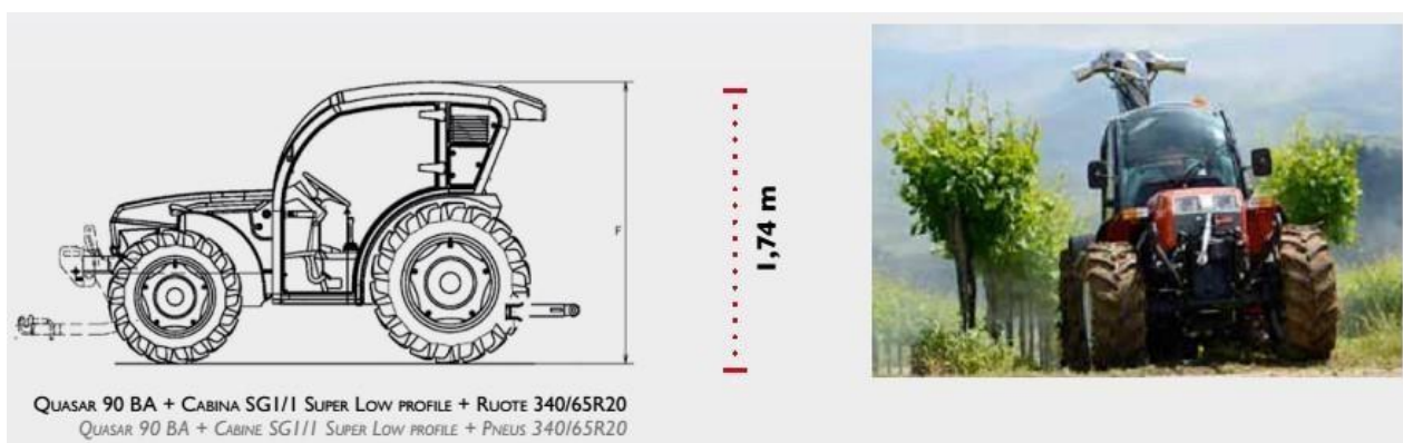
Figura 20) Dimensioni caratteristiche di un trattore da frutteto con cabina standard (in basso) e cabina ribassata (in alto) (Foto: GOLDONI)
