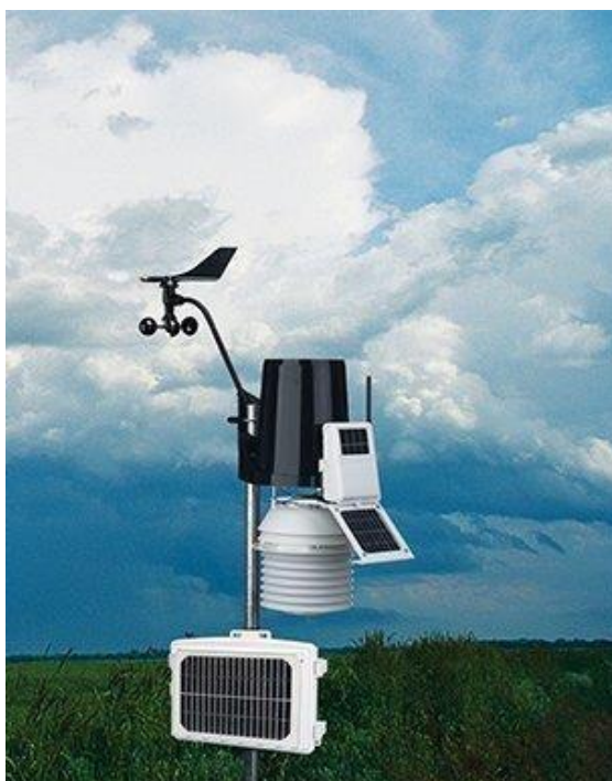
Figura 21) Esempio di stazione meteo completa alimentata da energia solare
