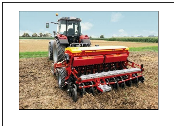
Figura 11) Esempio di seminatrice di precisione per tutte le tipologie di sementi (Foto: MaterMacc S.p.a.)
