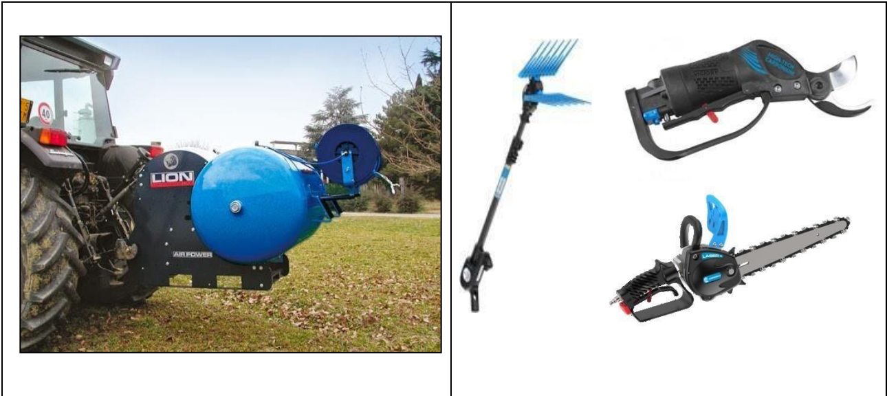
Figura 15) Compressore PTO per il funzionamento di strumenti pneumatici per l'arboricoltura (Foto: Campagnola)
