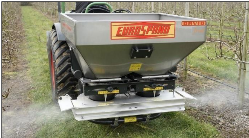
Figura 17) esempio di spandiconcime localizzato mono/bilaterale per frutteti (Foto: EuroSpand)
