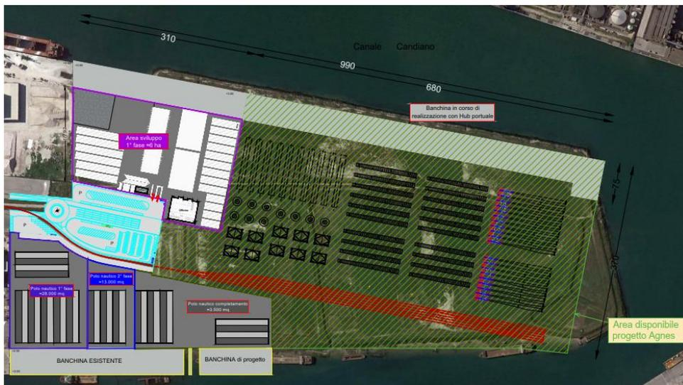
Figura 35: Ipotesi di stoccaggio: monopali, torri e pale in posizione orizzontale, elementi di transizione in posizione verticale, jacket in posizione verticale
