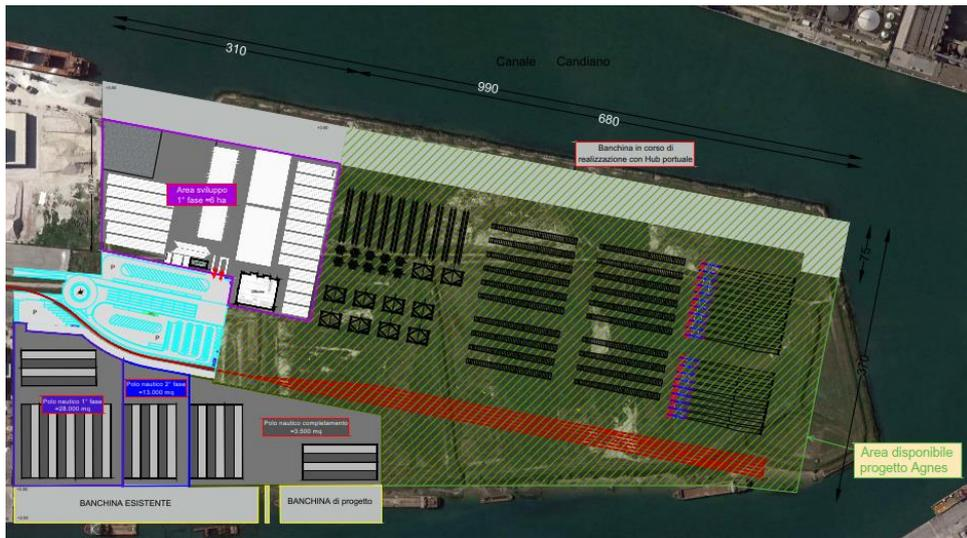
Figura 39: Ipotesi di stoccaggio: torri e pale in posizione orizzontale, componenti multipalo, jacket in posizione verticale
