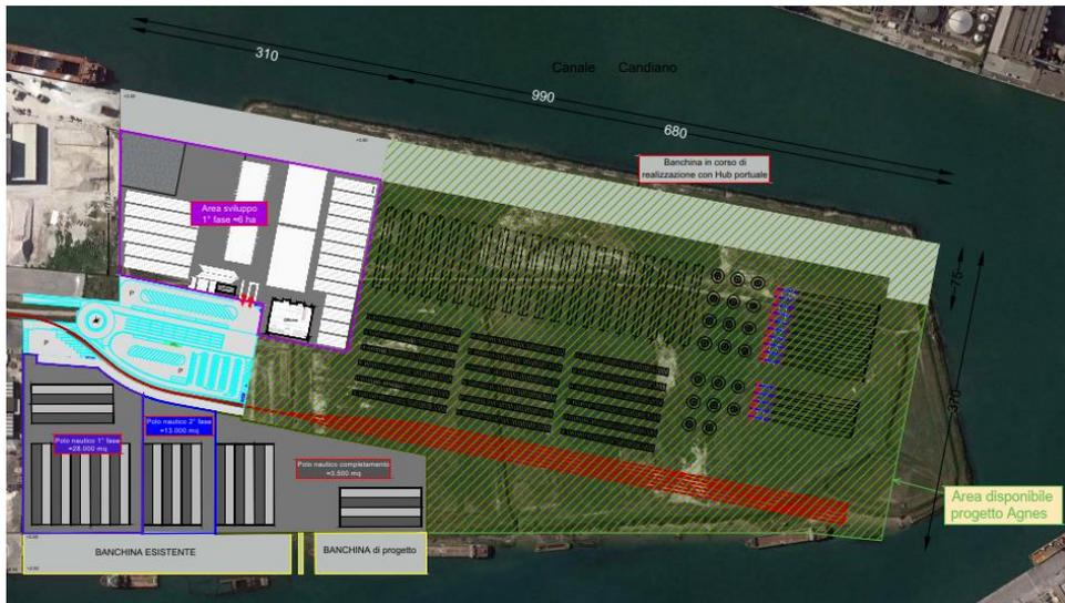
Figura 34: Ipotesi di stoccaggio: monopali, torri e pale in posizione orizzontale, elementi di transizione in posizione verticale
