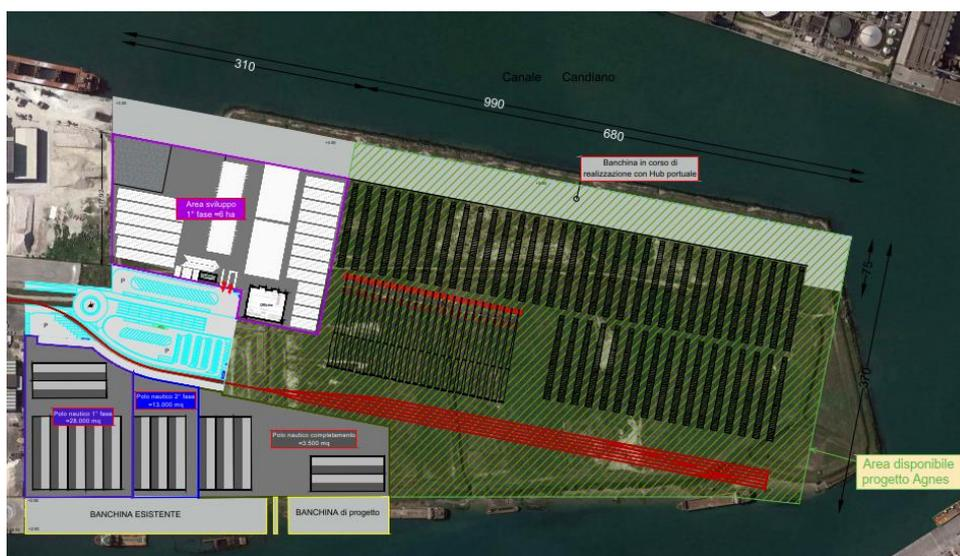
Figura 41: Ipotesi di stoccaggio: torri e pale in posizione orizzontale
