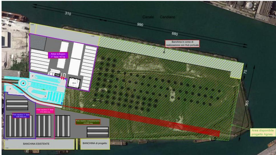
Figura 38: Ipotesi di stoccaggio: monopali ed elementi di transizione in posizione verticale
