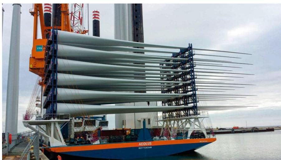
*Figura 52: Fase di carico in porto. Vista del supporto per il trasporto delle pale*
