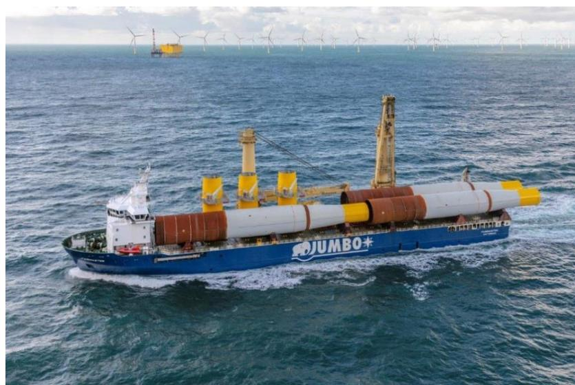
Figura 46: Nave HLV con monopali ed elementi di transizione fissati sul ponte della nave
