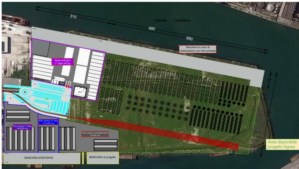
Figura 33: Ipotesi di stoccaggio: monopali e componenti multipalo in posizione orizzontale, elementi di transizione in posizione verticale
