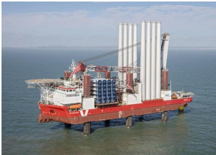
Figura 53: Nave carica con componenti degli aerogeneratori (torri, navicelle, pale) posizionata al sito di installazione.
