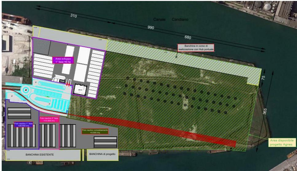
Figura 30: Ipotesi di stoccaggio: monopali in posizione verticale
