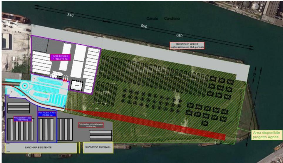
Figura 32: Ipotesi di stoccaggio: monopali in posizione orizzontale, jacket ed elementi di transizione in posizione verticale
