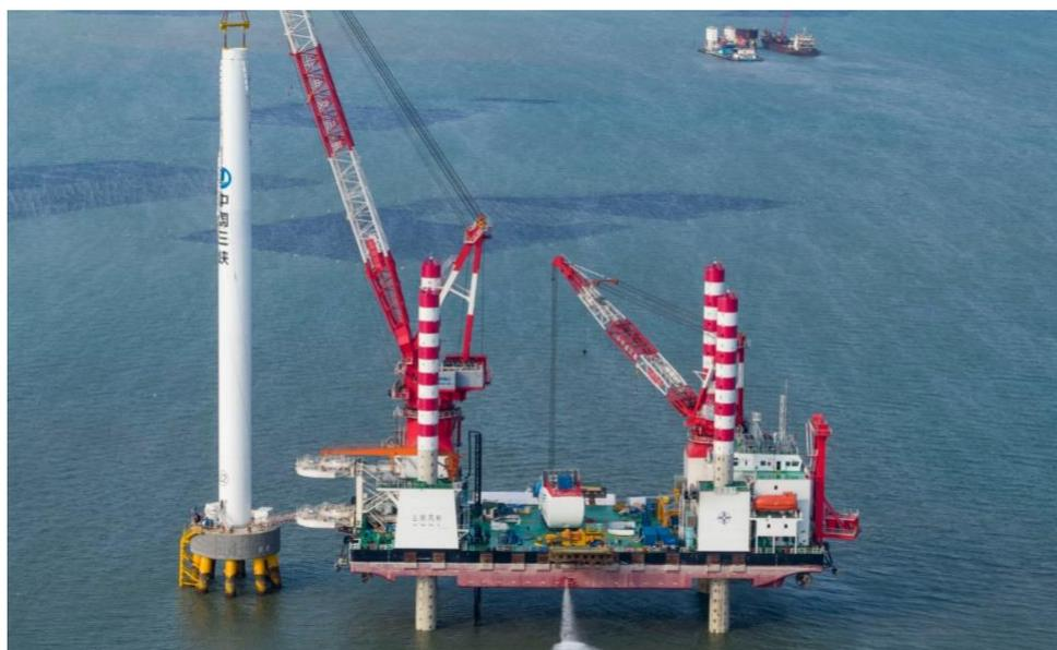
Figura 69: Esempio di installazione torre dell'aerogeneratore
