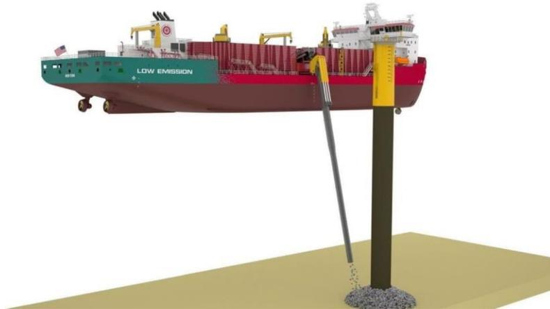
Figura 58: Esempio installazione di scour protection
