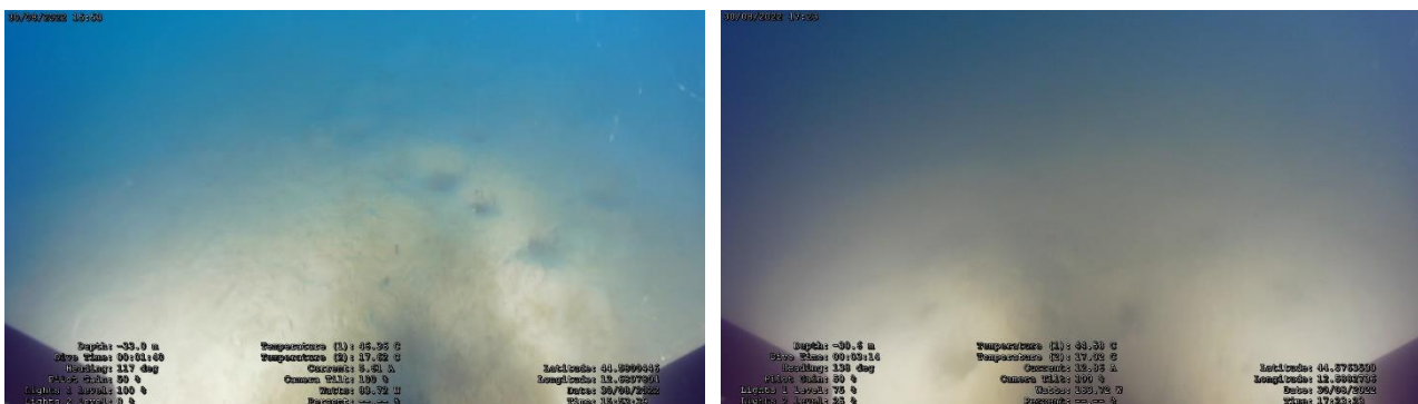
Figura 29: Fondali incoerenti di natura siltosa e segni di bioturbazione sui target ispezionati.
