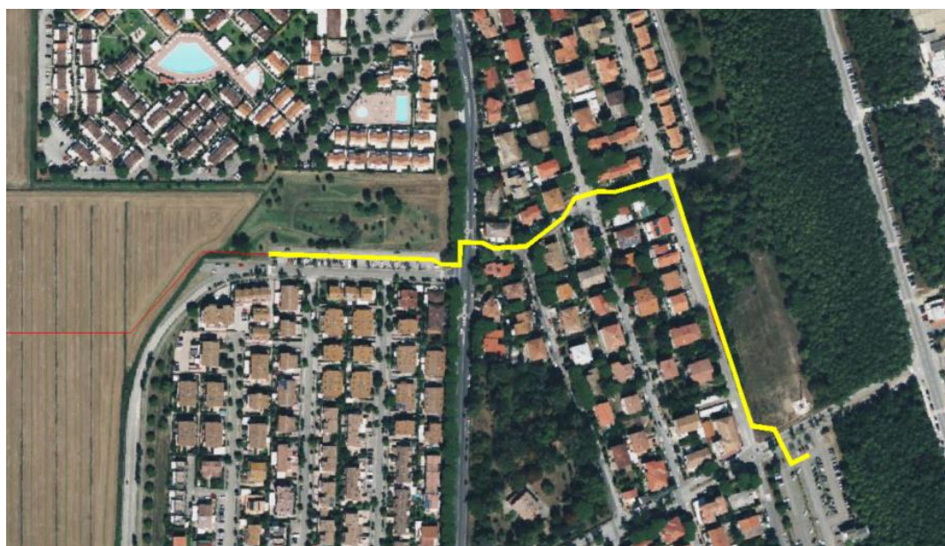
Figura 75: Visuale ravvicinata del tratto stradale impegnato dai cavi da 220kV
