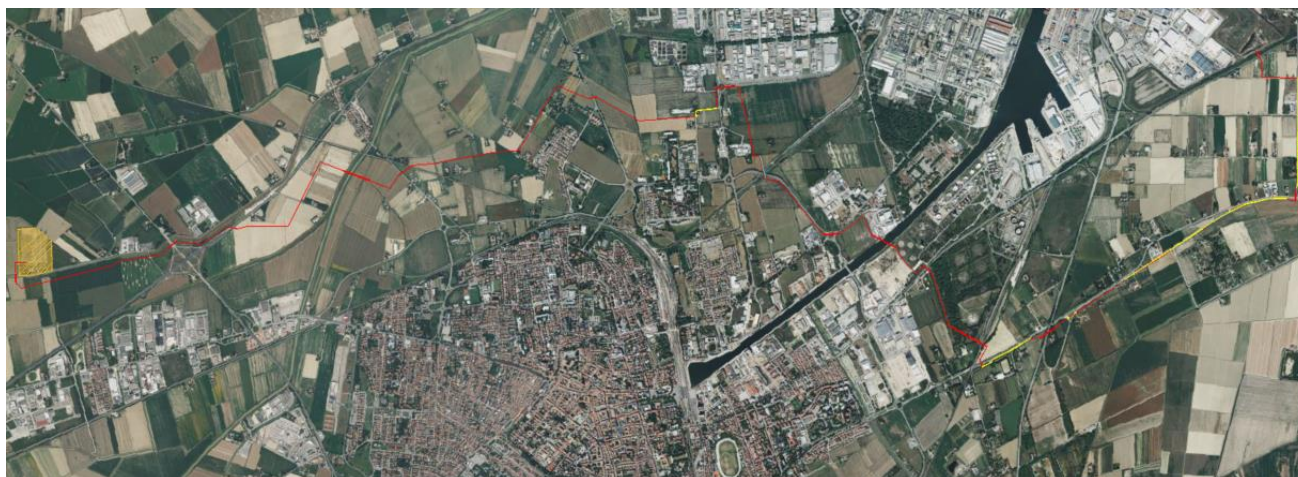
Figura 76: Percorso cavi terrestri da 380 kV. Tratto terreno agricolo in rosso, tratto terreno stradale in giallo
