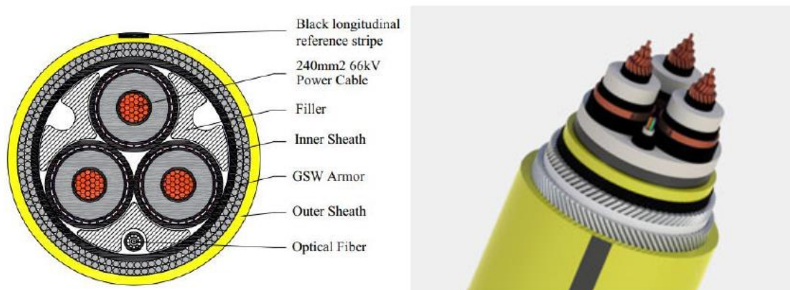
Figura 66: Stratigrafia cavo dinamico 66 kV
