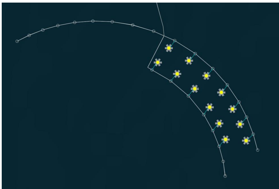
Figura 8: Layout definitivo dell'impianto fotovoltaico galleggiante
