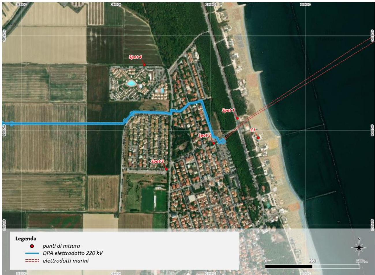
Figura 7-12: Campagna di caratterizzazione del clima acustico (2022) – Area Elettrodotto Interrato 220 kV.
