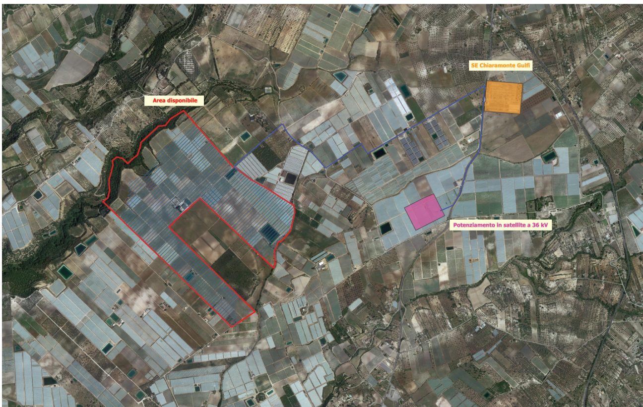
Figura 4: inquadramento territoriale area di impianto su ortofoto, con indicazione del tracciato della dorsale in cavo interrato a 36 kV di collegamento con il futuro potenziamento in satellite a 36 kV della Stazione Elettrica di Chiaramonte Gulfi
