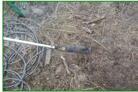
Fig. 3 geofono tridimensionale da 4,5 Hz
