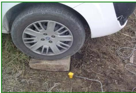
Fig. 4 Sorgente di acquisizione costituita da traversina in legno, massa battente e geofono starter
