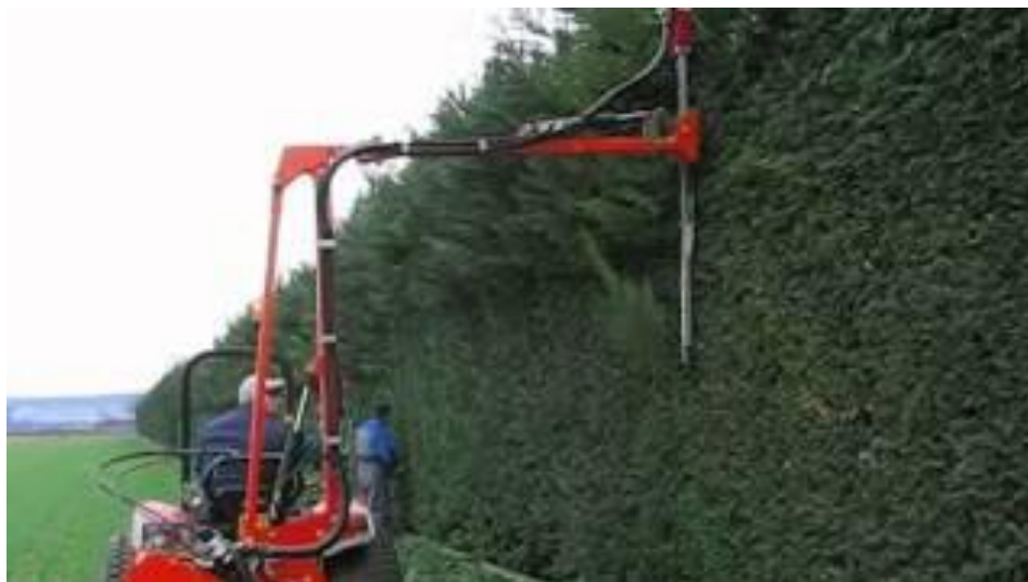
Esempio di potatrice meccanica frontale a doppia barra (taglio verticale + topping) utilizzabile su tutti le colture arboree perimetrali
