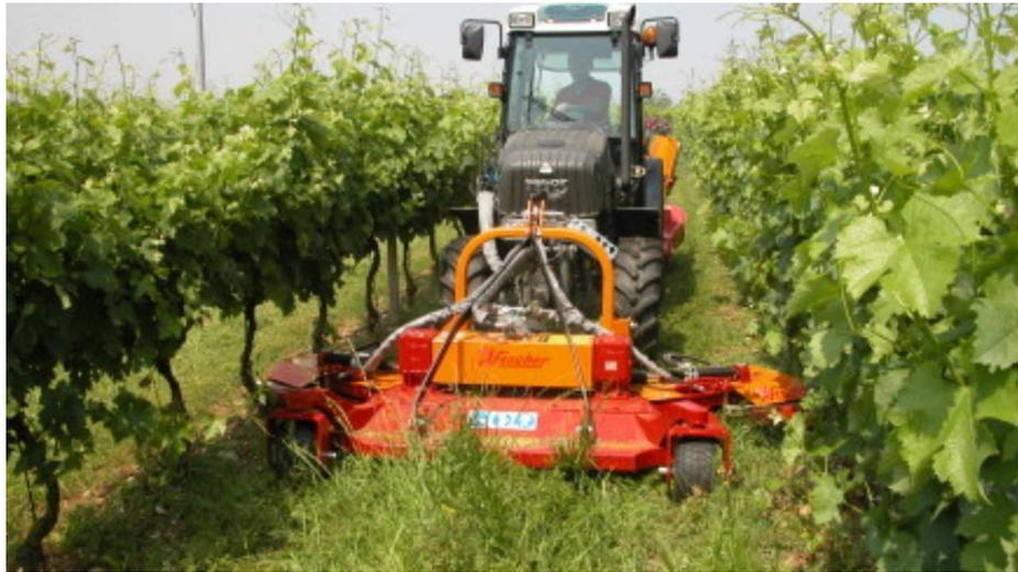
**Figura 1** *Trinciatura erbai in vigneto a spalliera*
