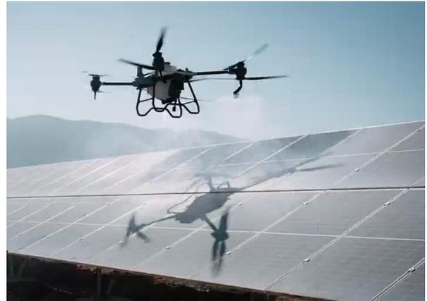
Figura 3 – Esempi di pulizia meccanica tramite droni
