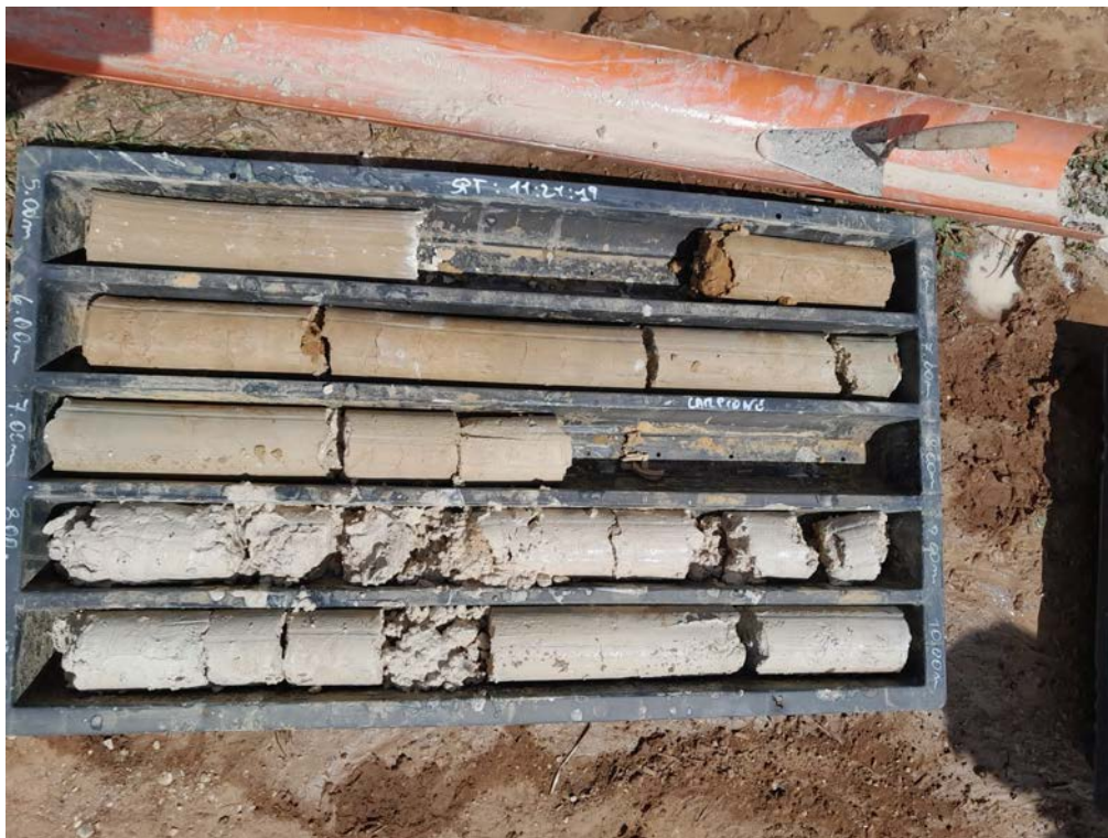
Sondaggio meccanico 1 - Carotaggio da 5.00 a 10.00 metri
