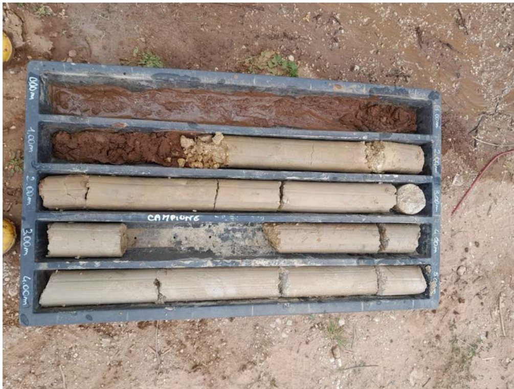
Sondaggio meccanico 1 - Carotaggio da 0.00 a 5.00 metri
