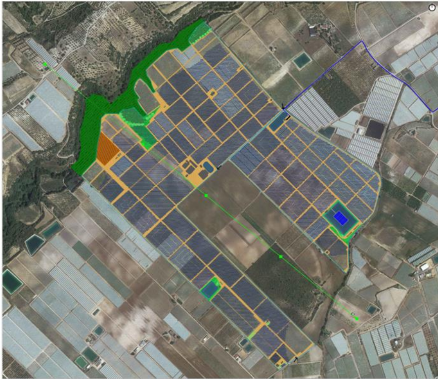
Figura 2 - Layout dell'impianto agro bio fotovoltaico su ortofoto
