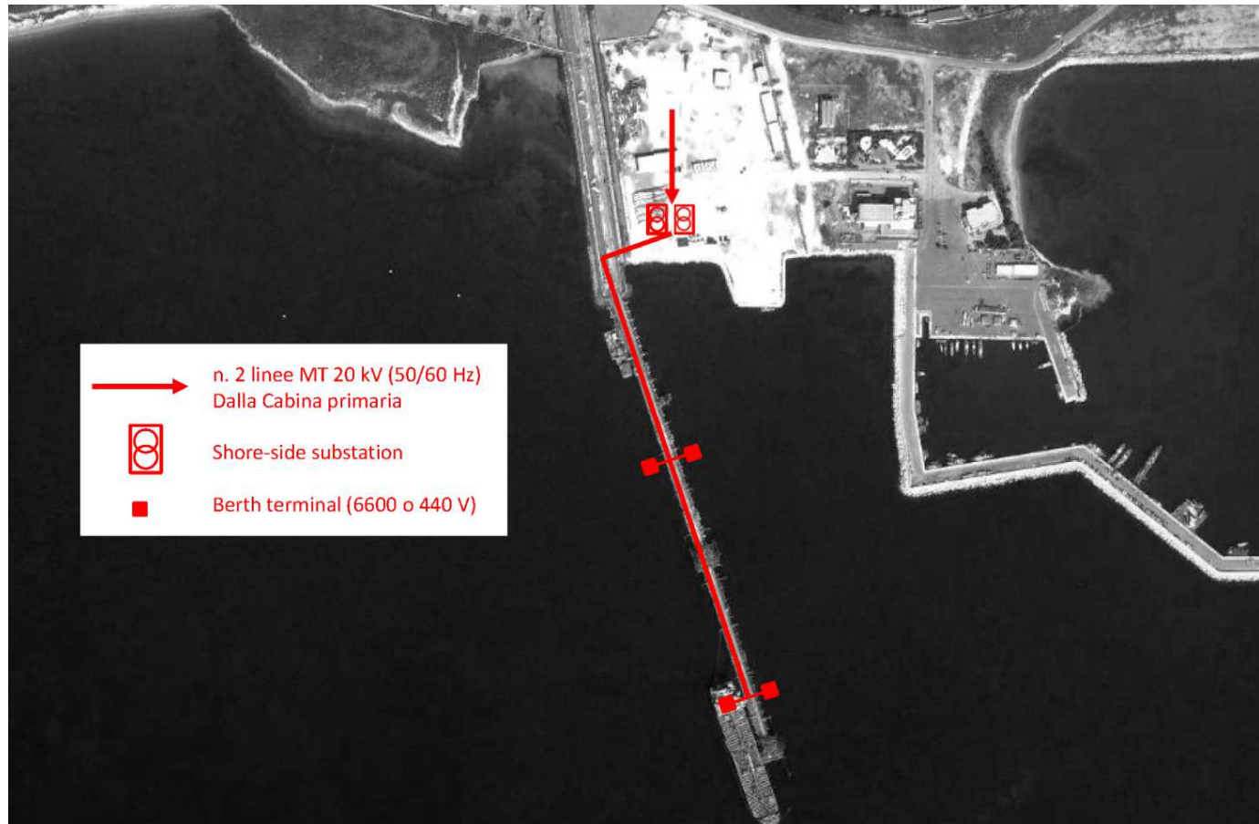
Figura 12 - Soluzione per l'elettrificazione del Pontile Petrolifero
