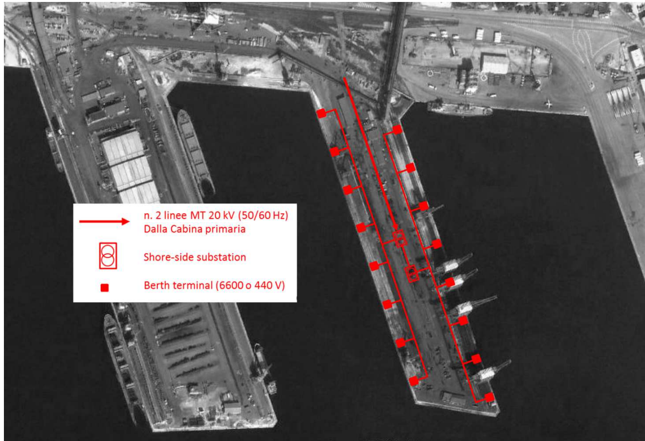
Figura 13 - Soluzione per l'elettrificazione dello Sporgente 2
