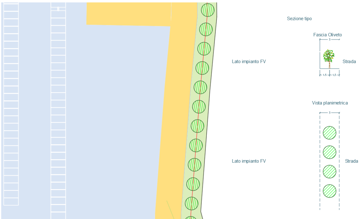
FIGURA 16 - SESTO D'IMPIANTO FASCIA DI MITIGAZIONE PERIMETRALE MONOFILA
