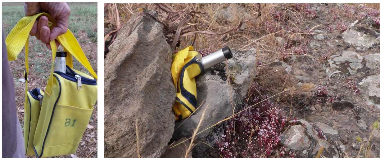
FIGURA 24 - I BAT DETECTOR UTILIZZATI NEL MONITORAGGIO PRELIMINARE DEI CHIROTTERI: I MICROFONI AUDIO-ULTRASONICI ULTRAMIC 384K DI DODOTRONIC. ESSI REGISTRANO I CONTATTI ULTRASONICI FULL SPECTRUM CON UNA FREQUENZA DI 384 KHZ E CON FILE WAV DI DURATA DI 5 SECONDI.
