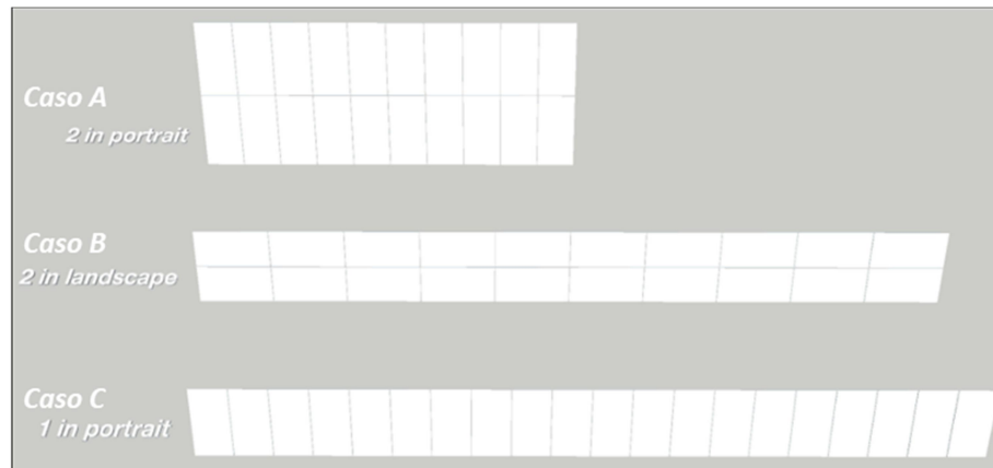
Figura 9 – Differenti configurazioni degli inseguitori solari monoassiali
