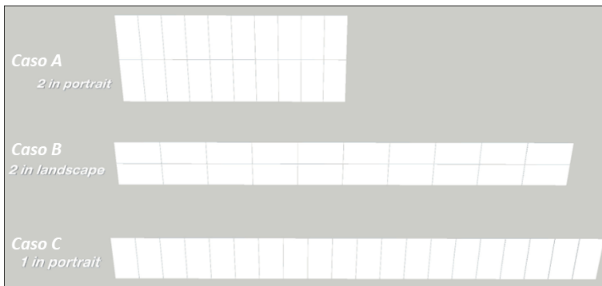
Figura 9 - Differenti configurazioni degli inseguitori solari monoassiali
