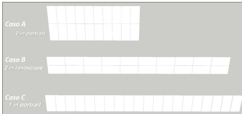
Figura 19 - Differenti configurazioni degli inseguitori solari monoassiali
