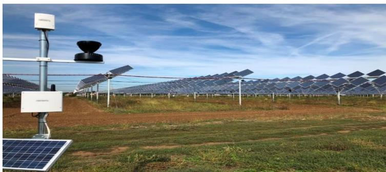
**Figura 5 - Stazione di monitoraggio ambientale del tipo Netsense o equivalente**
