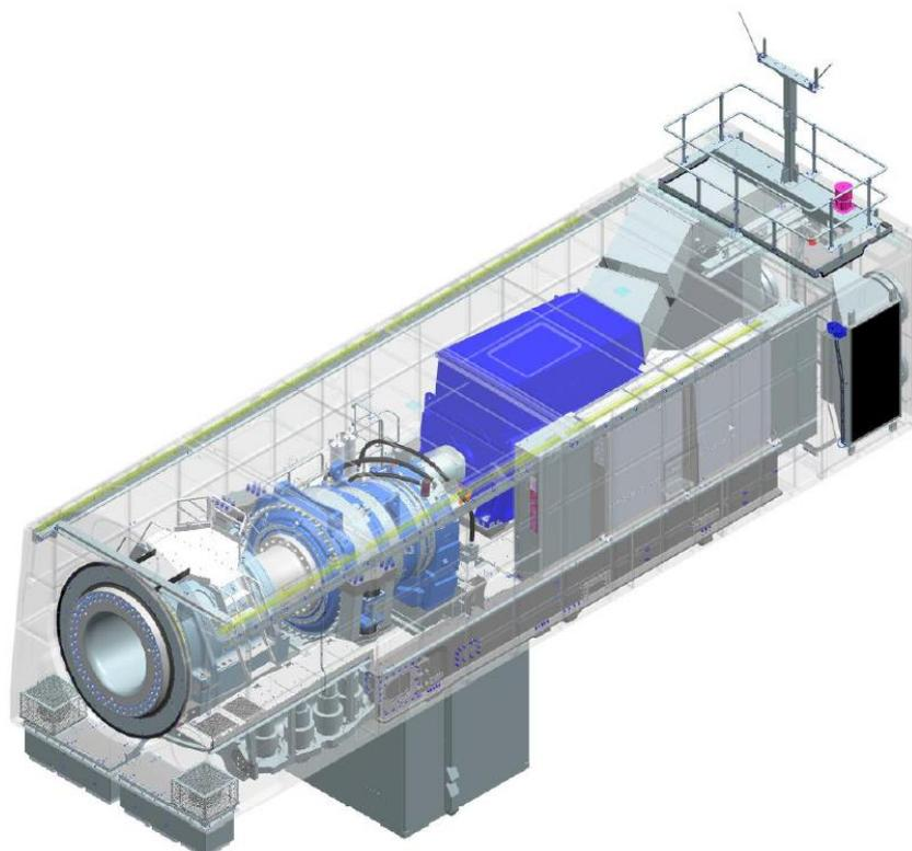
Figura 2.2 - Struttura tipica della navicella
