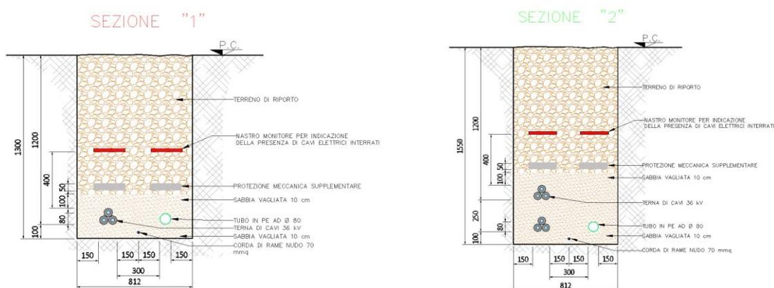
Figura 2.3: Sezione tipo posa cavidotti
