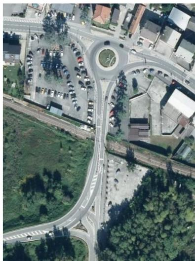
Attualmente la tangenziale di Sondrio si innesta mediante intersezione a rotatoria sul tracciato storico della SS38, dopo aver attraversato a raso la linea ferroviaria Sondrio – Tirano. Immediatamente a sud del passaggio a livello si trova l'intersezione (regolata a semplice precedenza con corsie canalizzate) con la SP19 di Piateda.
