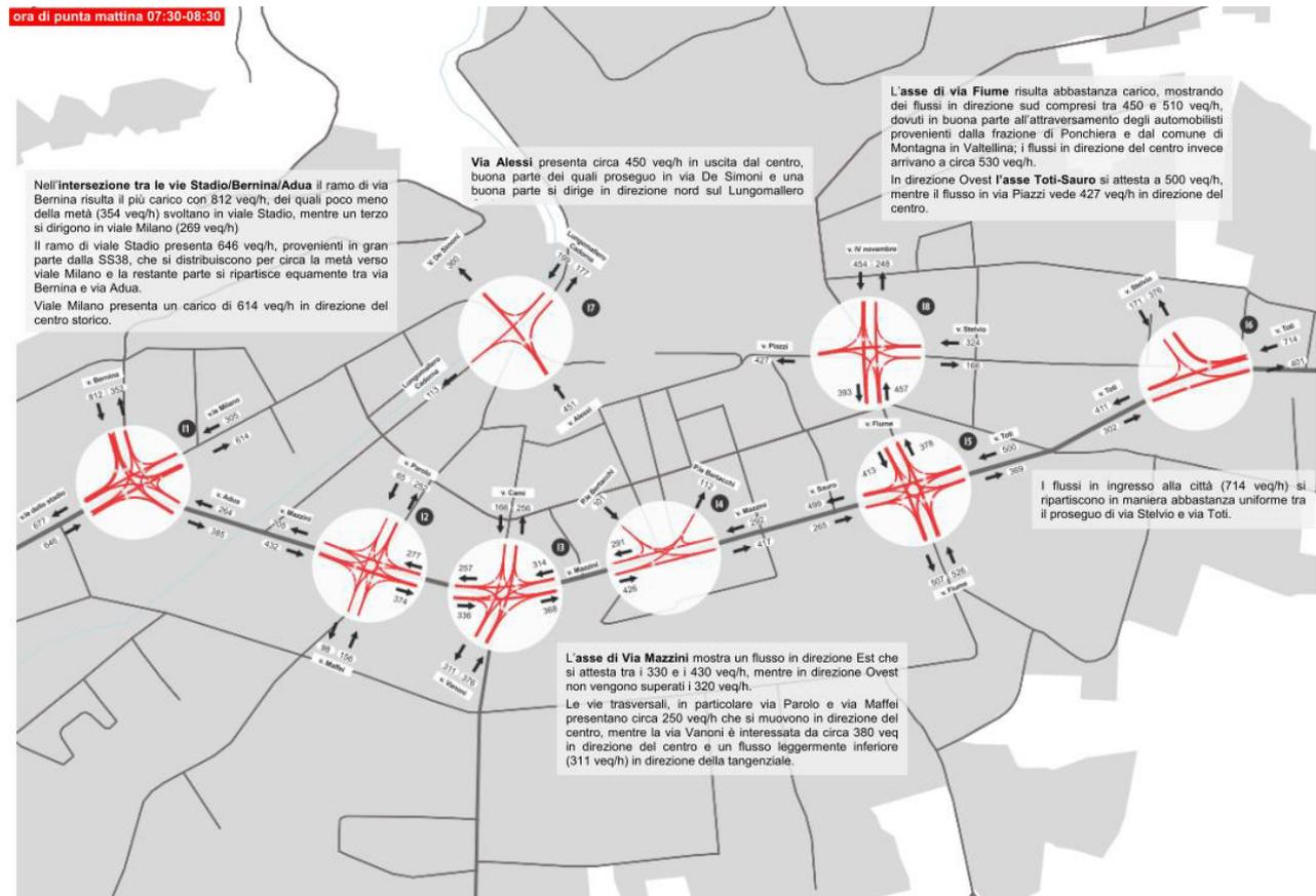
Fig. 2.xi – Flussi nell’ora di punta, principali intersezioni urbane di Sondrio
