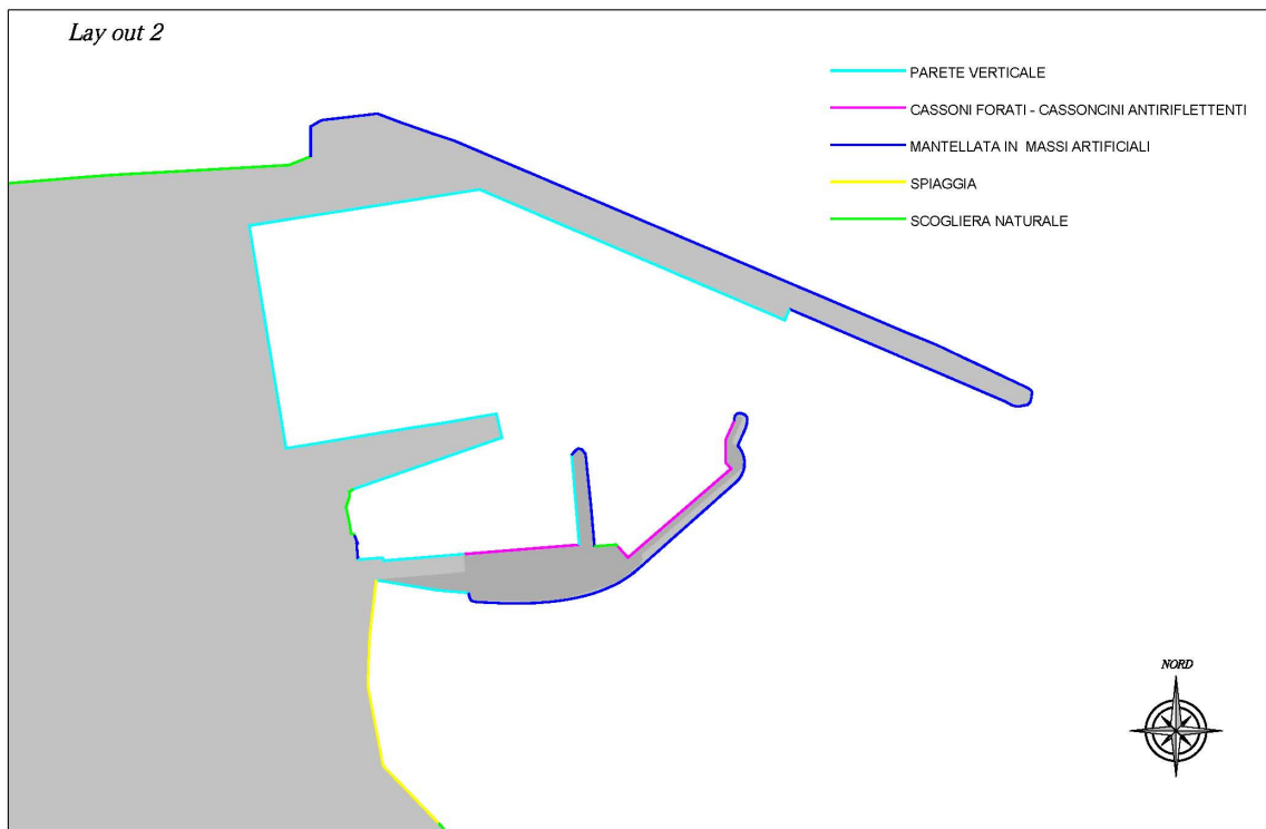
Figura 7 – Layout 2 (Completamento della diga di sottoflutto – ultimo tratto lato mare mantellato): Valori dei coefficienti di riflessione
