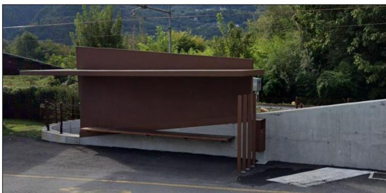
Figura 8 esempio di accostamento finiture in cor-ten a cemento rasato, sullo sfondo contesto naturale utilizzato nella zona di intervento lungo la direttrice ferroviaria e stradale
