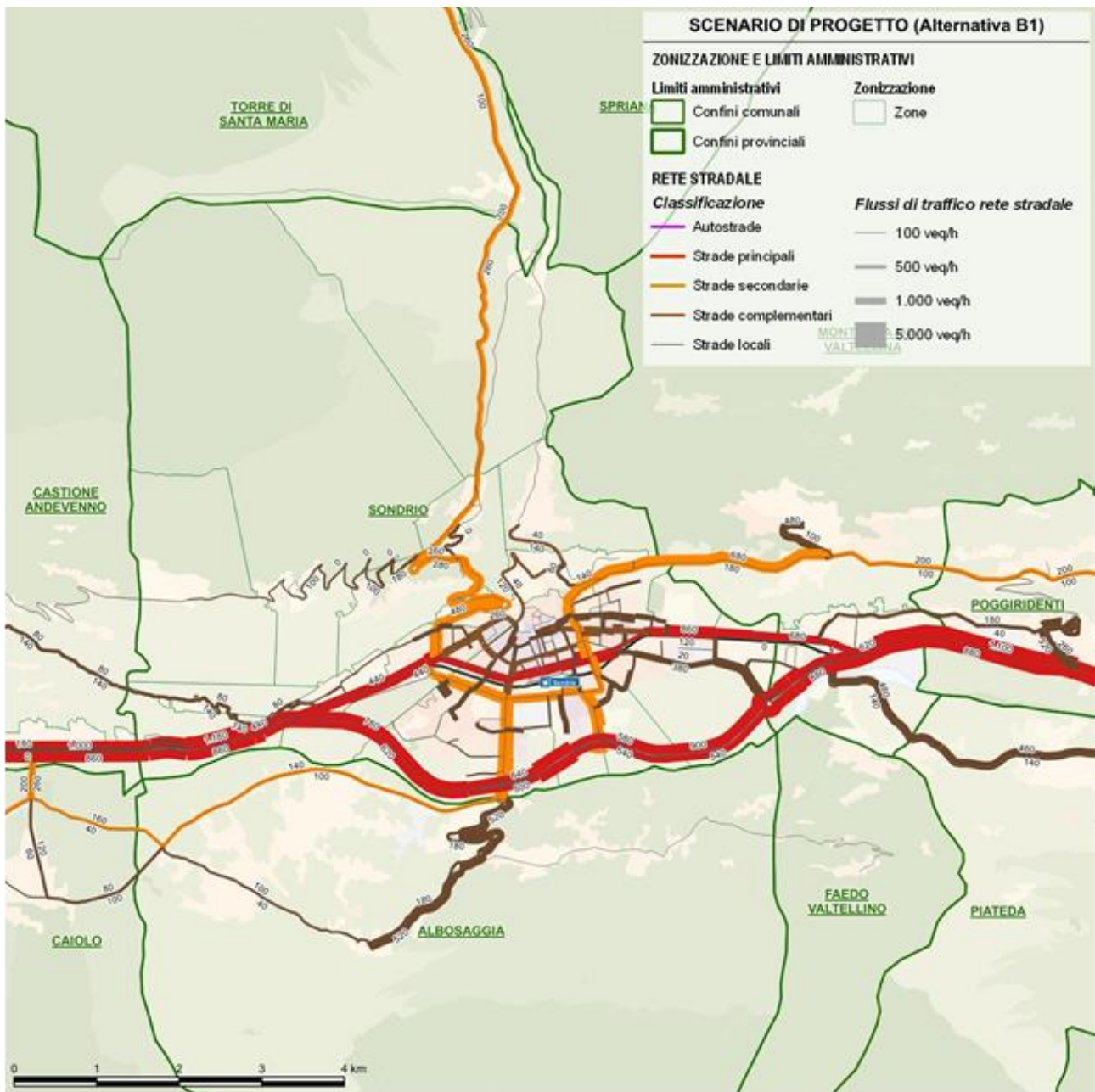
Figura 6 – Flussogramma situazione post-operam (alternativa progettuale B1)
