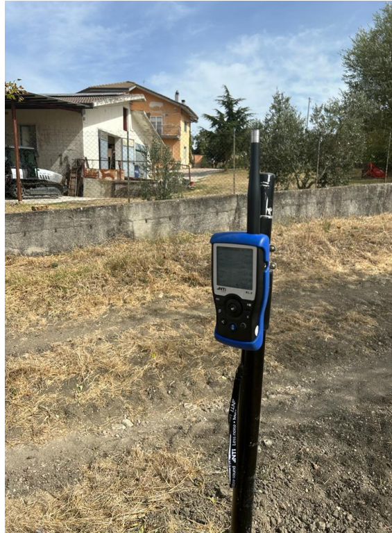
Foto scattata in data 19 settembre 2023 durante la campagna di misura del rumore di fondo in sito
