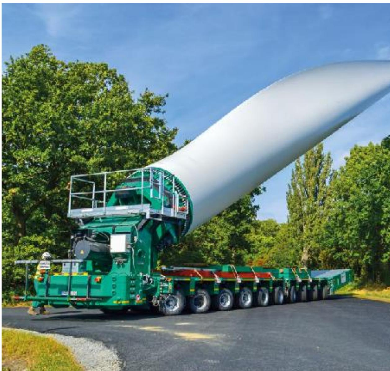
*Figura 4 – Blade lifter, utilizzato per il trasporto di pale per aerogeneratori*
