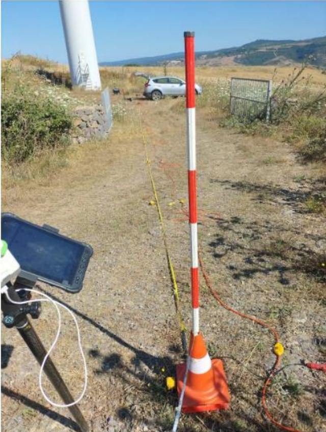
**Sismica a Rifrazione/MASW R2-M2
