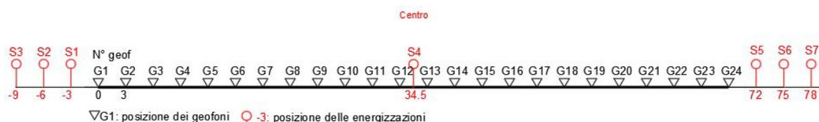
**Figura 45 Geometria di acquisizione - MASW con 24 geofoni, interdistanza di 3,0 m, lunghezza complessiva 69,0**
