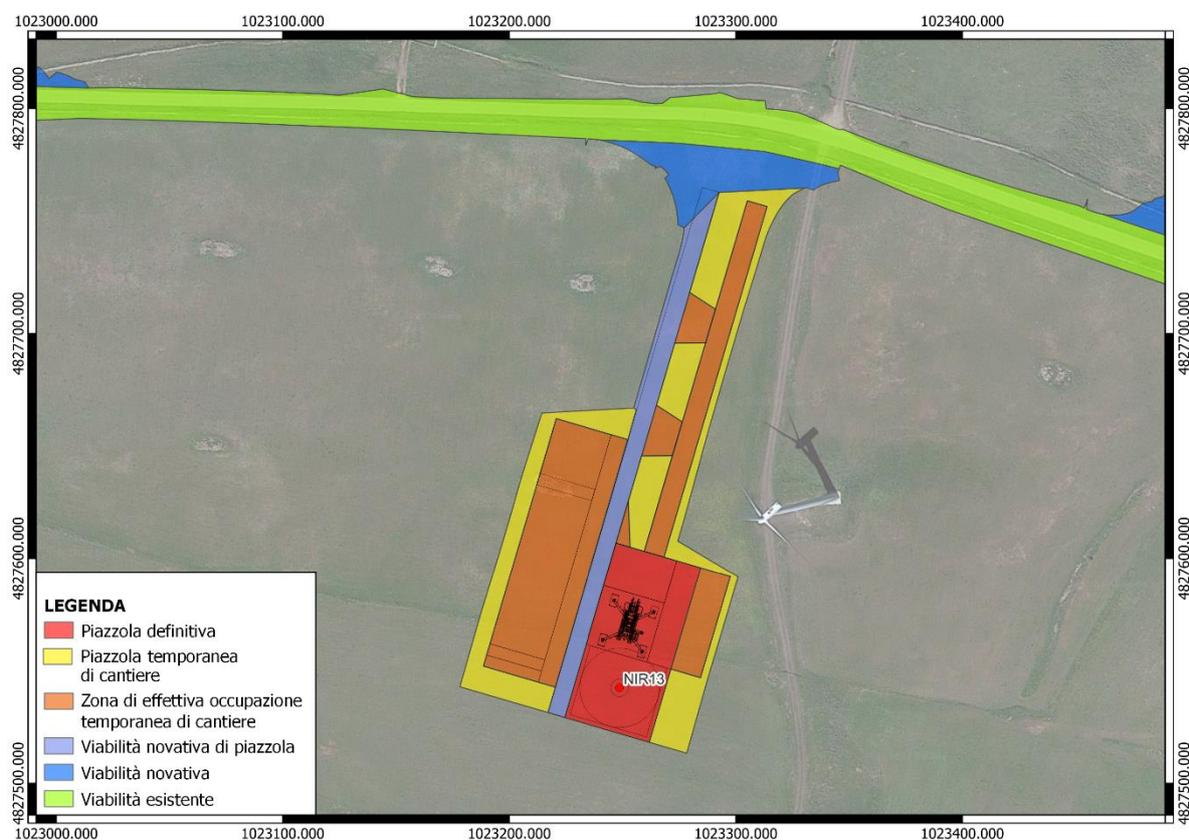
Figura 84: Classificazione delle superfici coinvolte dalle attività di cantiere nell'ambito dell'installazione dell'aerogeneratore NR113
