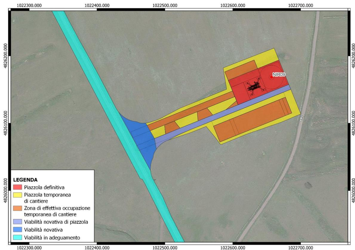
Figura 80: Classificazione delle superfici coinvolte dalle attività di cantiere nell'ambito dell'installazione dell'aerogeneratore NRI09
