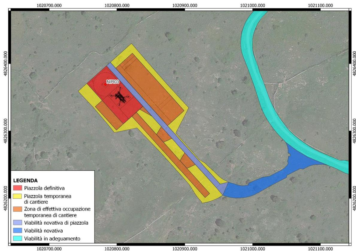
Figura 74: Classificazione delle superfici coinvolte dalle attività di cantiere nell'ambito dell'installazione dell'aerogeneratore NRI03
