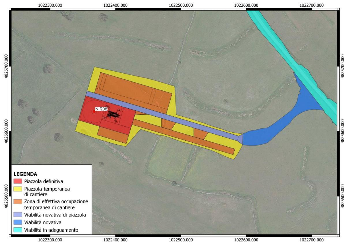
Figura 79: Classificazione delle superfici coinvolte dalle attività di cantiere nell'ambito dell'installazione dell'aerogeneratore NRI08
