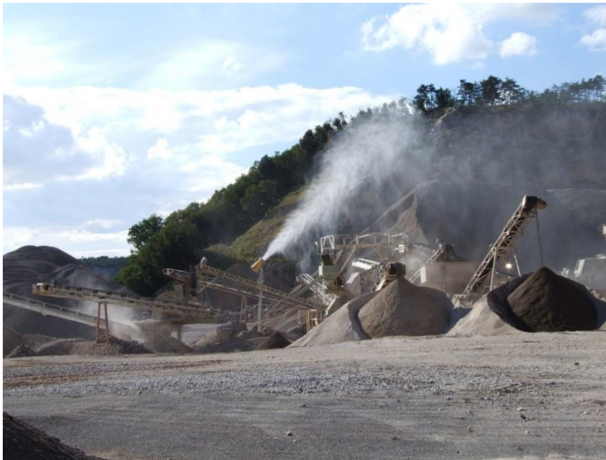
Figura 8.1: Esempio di nebulizzatore utilizzato nel ciclo di stoccaggio di inerti
