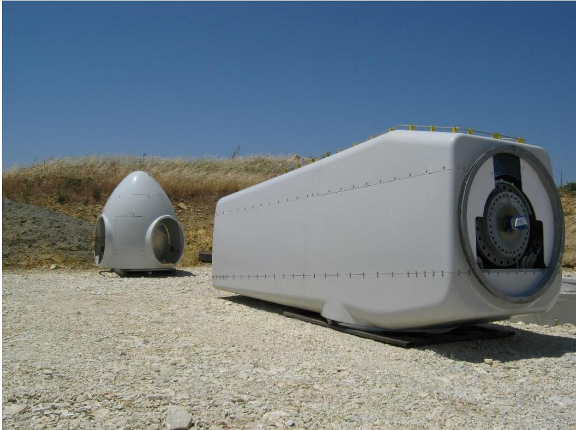
Figura 6.33: Navicella e hub Aerogeneratore V52 Collocati a terra
