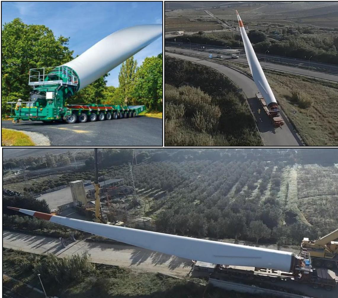
**Figura 6.29: “Blade lifter”, Utilizzati per il Trasporto di Pale per Aerogeneratori**
