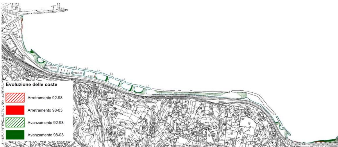
**Figura 4.20 – Evoluzione della linea di riva. Tratto compreso tra il molo di sottoflutto del Porto di Terminì Imerese e l'indotto industriale. Stima dei tratti in avanzamento o in arretramento. Fonte di riferimento: Cartografia allegata alla relazione dell' U.F.18 del P.A.I. della Regione Sicilia (2006).**
