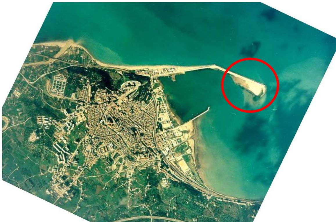
**Figura 4.13 – Evoluzione della linea di riva. Volo del 01/10/1976. Stralcio areofotogrammetrico. Produzione S.A.S. Palermo. Fonte: Piano Regolatore del Porto di Termini Imerese (Anno 2003).**
