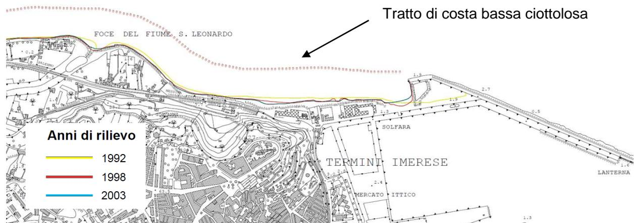
**Figura 4.17 – Evoluzione della linea di riva. Tratto compreso tra la foce del Fiume S. Leonardo e la radice del molo di sopraflutto del porto di Termini Imerese. Sovrapposizione tra le linee di riva. Fonte di riferimento: Cartografia allegata alla relazione dell' U.F.18 del P.A.I. della Regione Sicilia (2006).**
