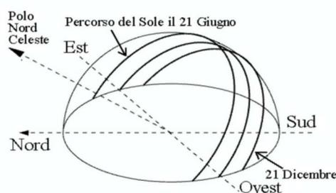
**Fig. 3 - Movimento apparente del disco solare per un osservatore situato ad una latitudine nord attorno ai 45°. Per tutte le località situate tra il Tropico del Cancro e il Polo Nord Geografico il disco solare non raggiunge mai lo zenit.**
