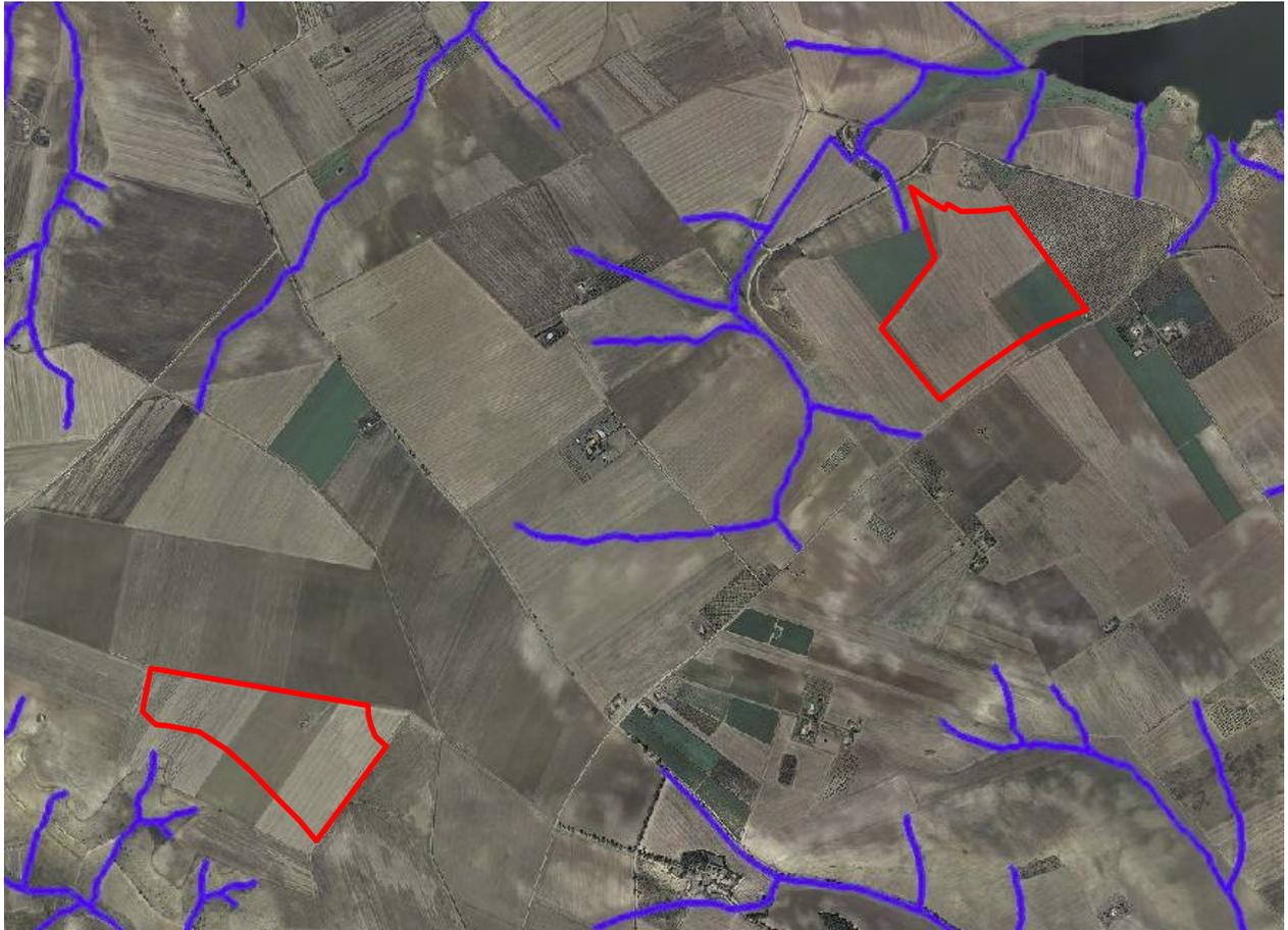
**Fig. 3 - Stralcio ortofotografico della Carta Idrogeomorfologica di AdBDAM con ubicazione dell'area di impianto che prevede l'installazione di pannelli fotovoltaici e cabine (cfr Relazione Idraulica)**
