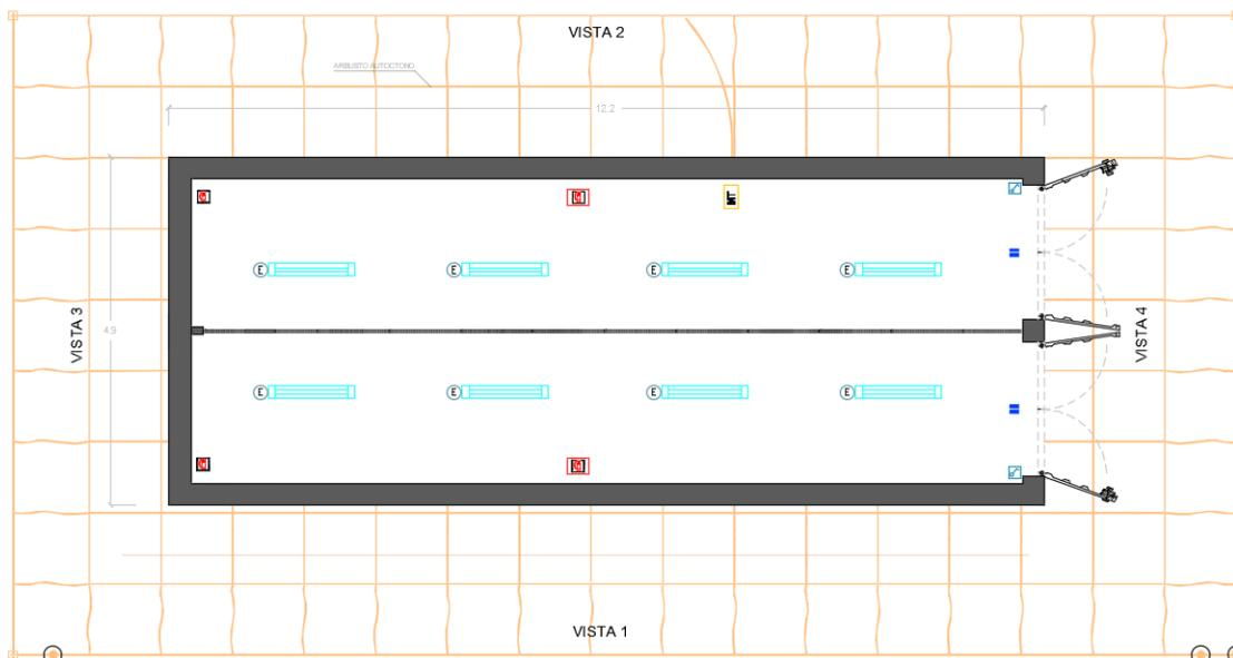
Figura 4-4 Posizionamento plafoniere Cabina Uffici
