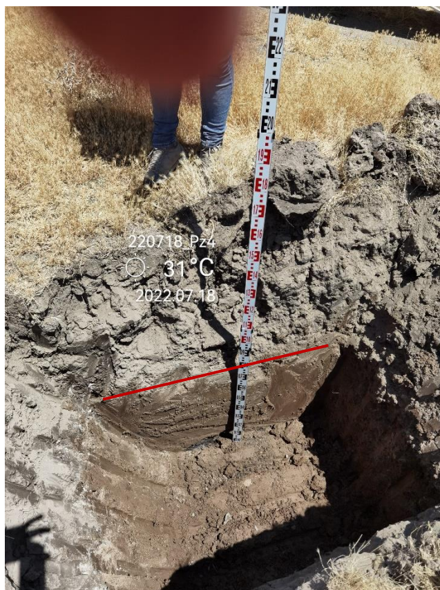
Foto 10 Saggi di scavo 220718_Pz5. In evidenza i limiti di strato
