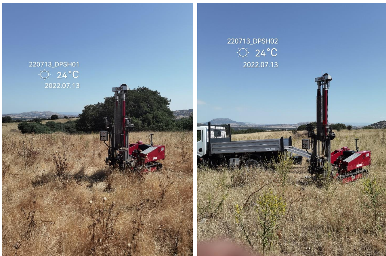
Foto 11, 12 Prove penetrometriche 220713_DPSH01 e 220713_DPSH02
