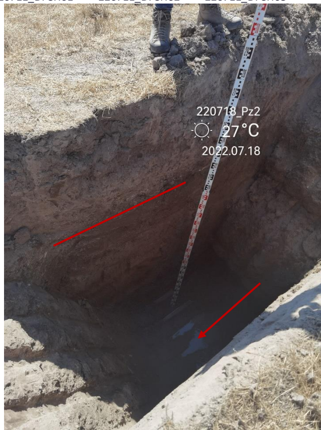
Foto 2, 3, 4, 5, 6, 7 Saggi di scavo 220718_Pz1 (in evidenza la falda), 220718_Pz2 (in evidenza la falda) e 220718_Pz3. Su tutti in evidenza i limiti di strato. Prove penetrometriche 220711_DPSH01 - 220711_DPSH02 - 220711_DPSH03
