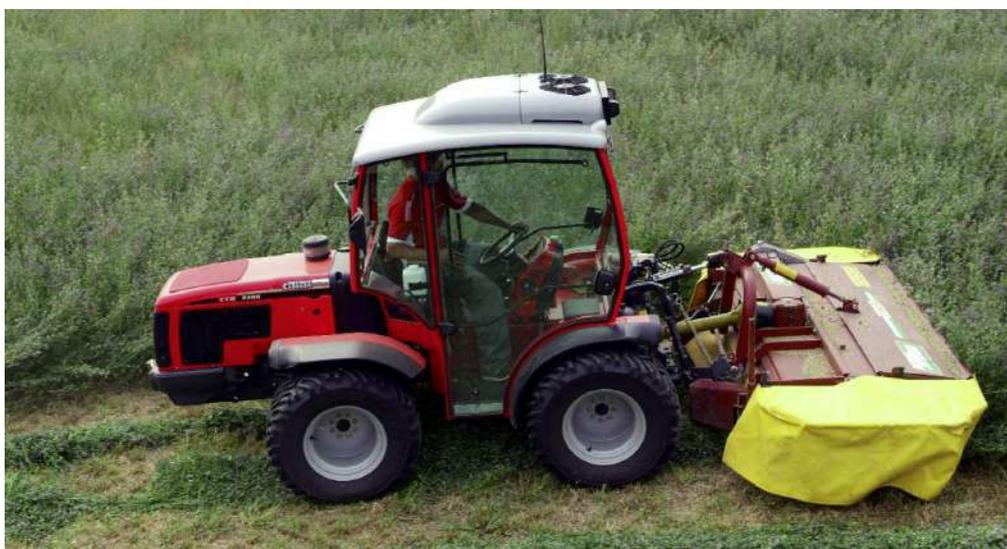
Figura 7.9: Esempio di falciaccondizionatrice frontale adatta a piccoli spazi (Foto: Bellon)
