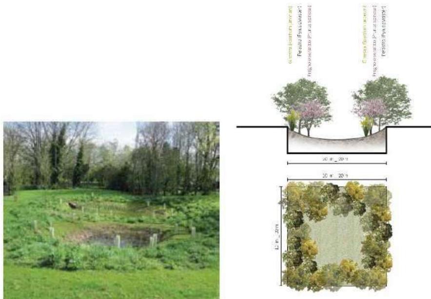
Figura 3-6: Immagini esemplificative di bacini di infiltrazione
