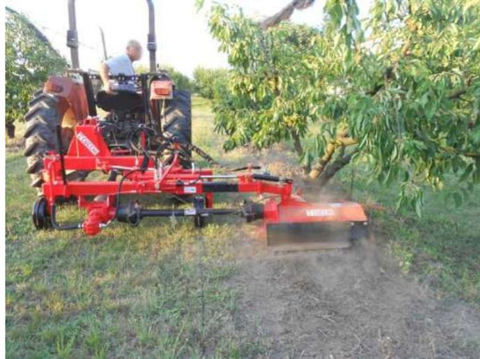
Figura 7.1: Esempio di fresatrice interceppo per le lavorazioni sulla fila (Foto: Cucchi Macchine Agricole)
