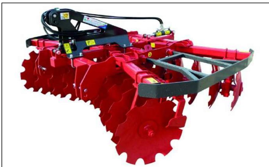
Figura 7.5: – Frangizolle per la preparazione del letto di semina
