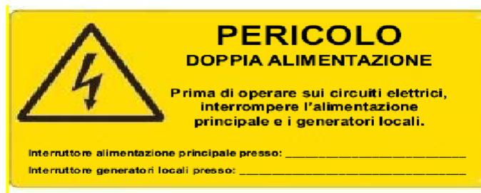
*Figura 22 - Segnaletica da utilizzare per i lavori sugli impianti FV*
