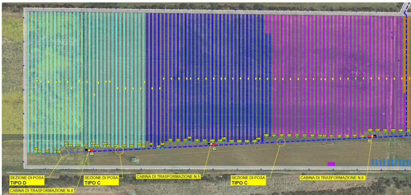
Figura 12 Planimetria porzione sud ovest impianto
