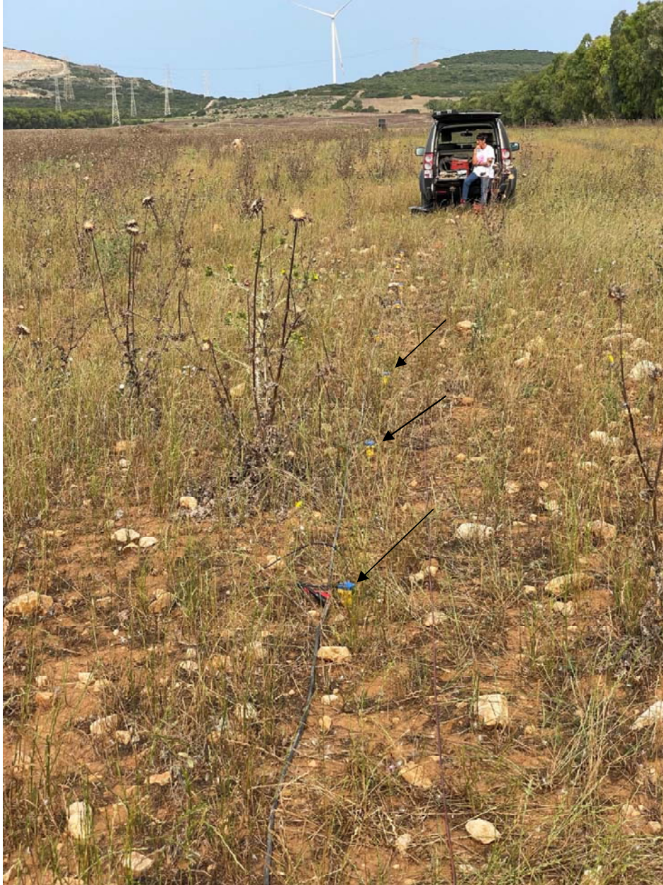
Foto n. 4 La stesa geofonica vista dal geofono n. 1
